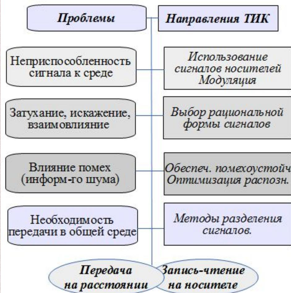
Исходный сигнал не всегда приспособлен к передаче — как голос на большие расстояния. Решение — использование несущего сигнала (например, радиоволн).
