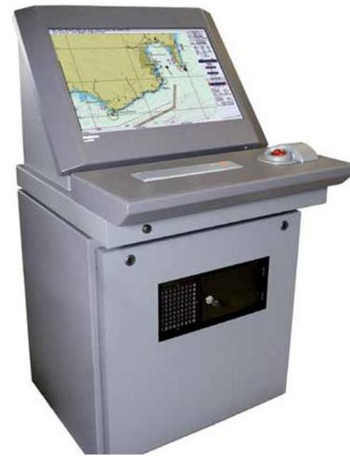
**Главный модуль НИС** устанавливается в рулевой рубке. Он включает в себя **системный блок, монитор, управляющую панель.**
