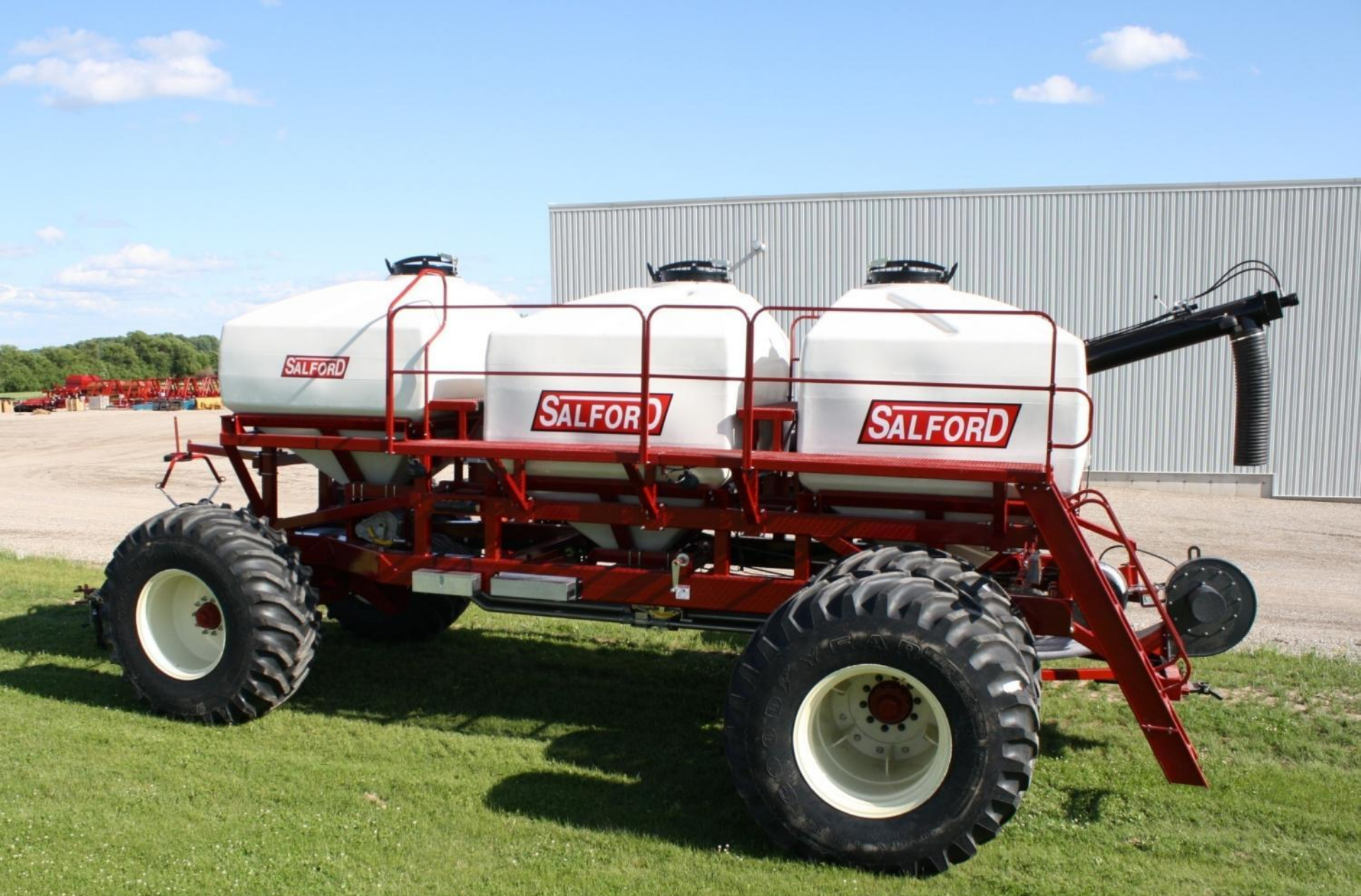
БУНКЕР АС 3555 заднеприцепной 19 500 литров, деление 6500 + 6500 + 6500 л. (15200 кг.
