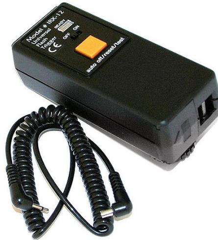
**ИК-пускатель.** Небольшая коробочка, устанавливается на место внешней вспышки фотокамеры (т.н. «hot shoe»). В момент открытия затвора она передаёт инфракрасный импульс. Приёмник моноблока, или генератора в фотостудии принимает его и поджигает студийную вспышку.
