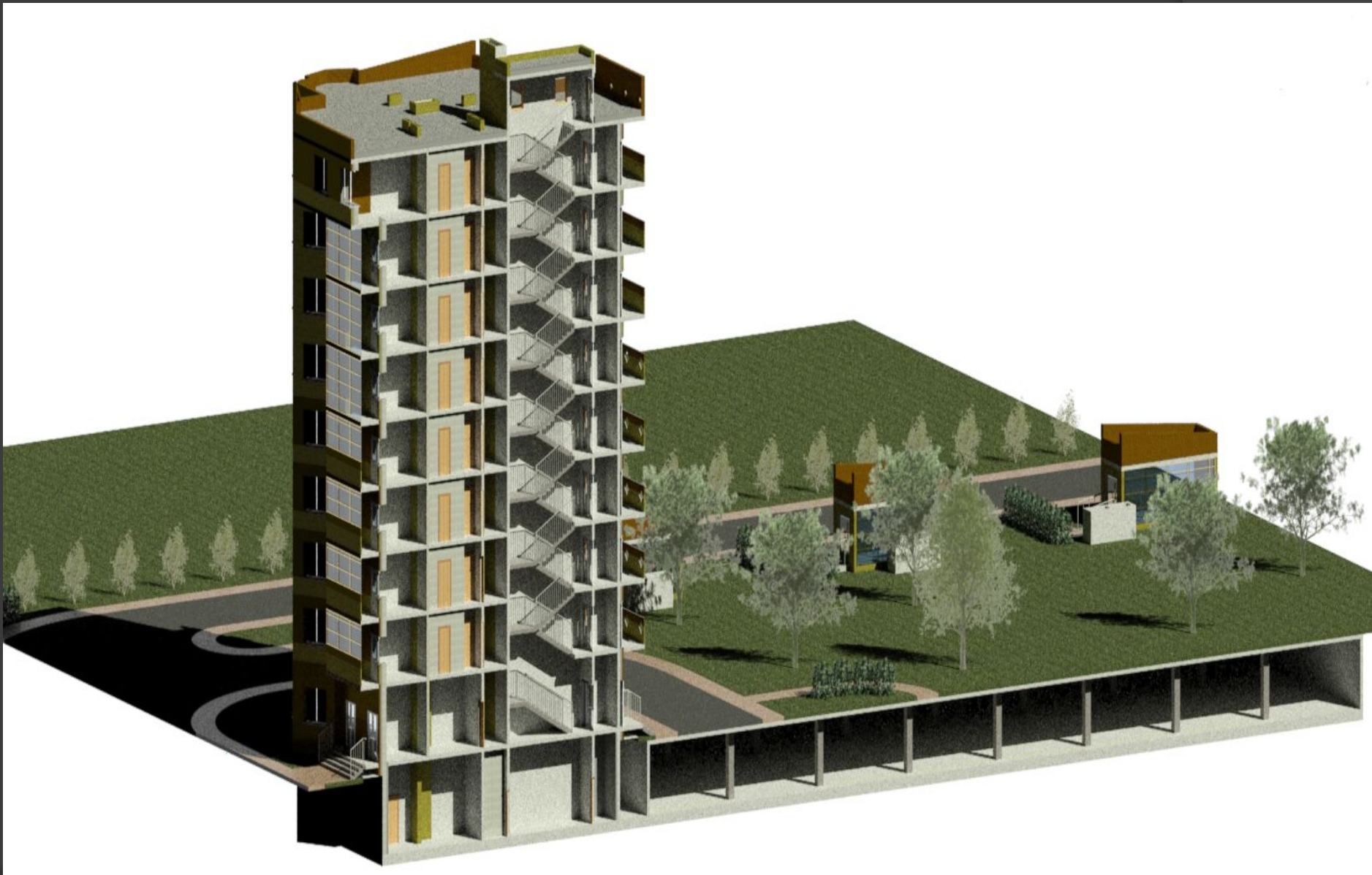
Рис.17.Трехмерный вид разреза по лестничной клетке
