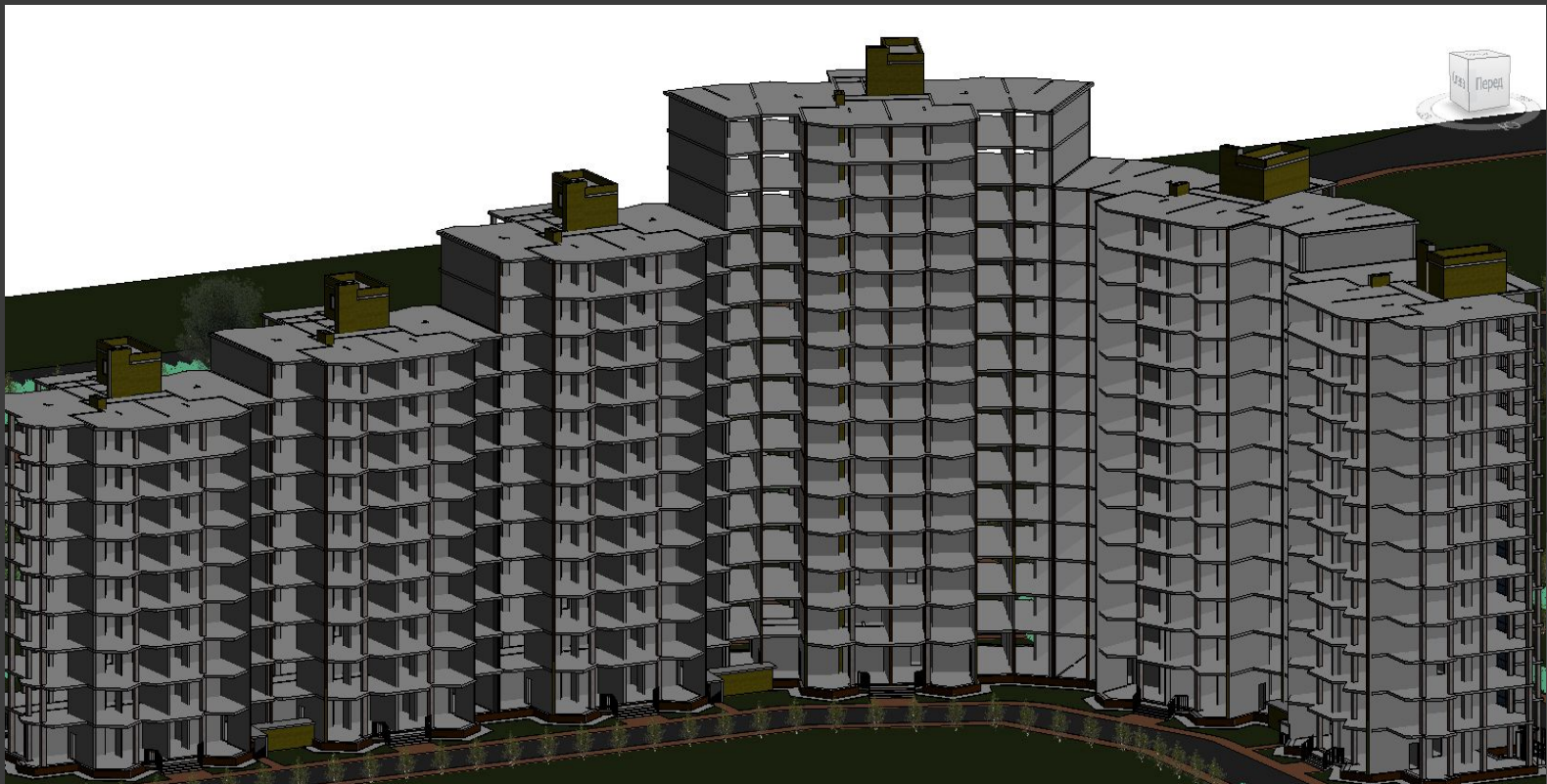
Рис.18.Трехмерный вид здания с несущими элементами
