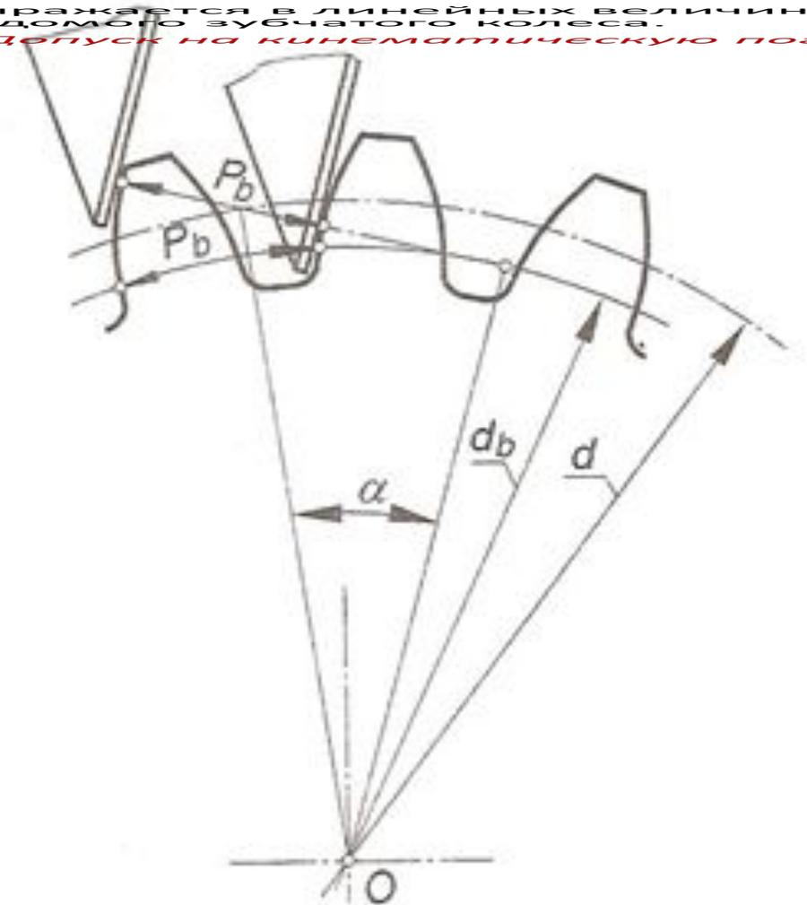
*Под действительным шагом зацепления понимается кратчайшее расстояние между двумя параллельными плоскостями, касательными к двум одноимённым активным боковым поверхностям соседних зубьев зубчатого колеса.*
