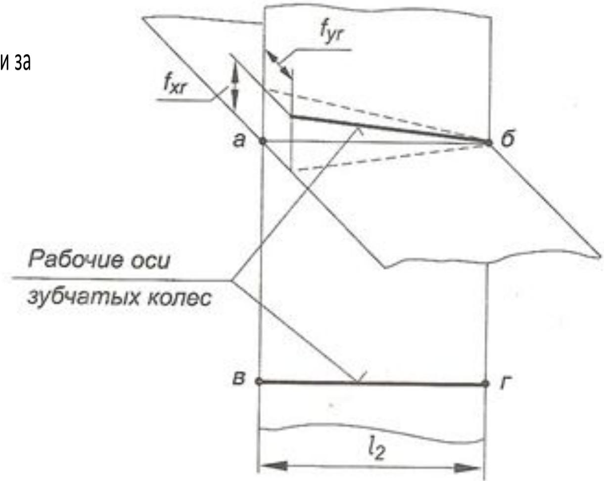
Выражается в линейных величинах длиной дуги делительной окружности ведомого зубчатого колеса.
