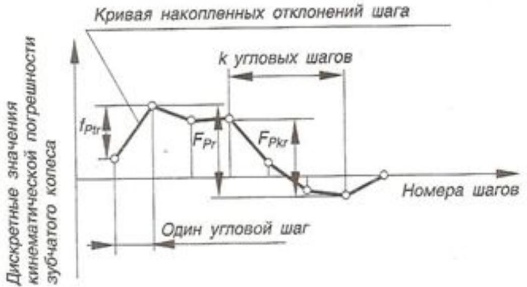
1. Наибольшая кинематическая погрешность передачи  $F'_{i0r}$  - наибольшая алгебраическая разность значений кинематической погрешности колес передачи за полный цикл измерения относительного положения зубчатых колес.
