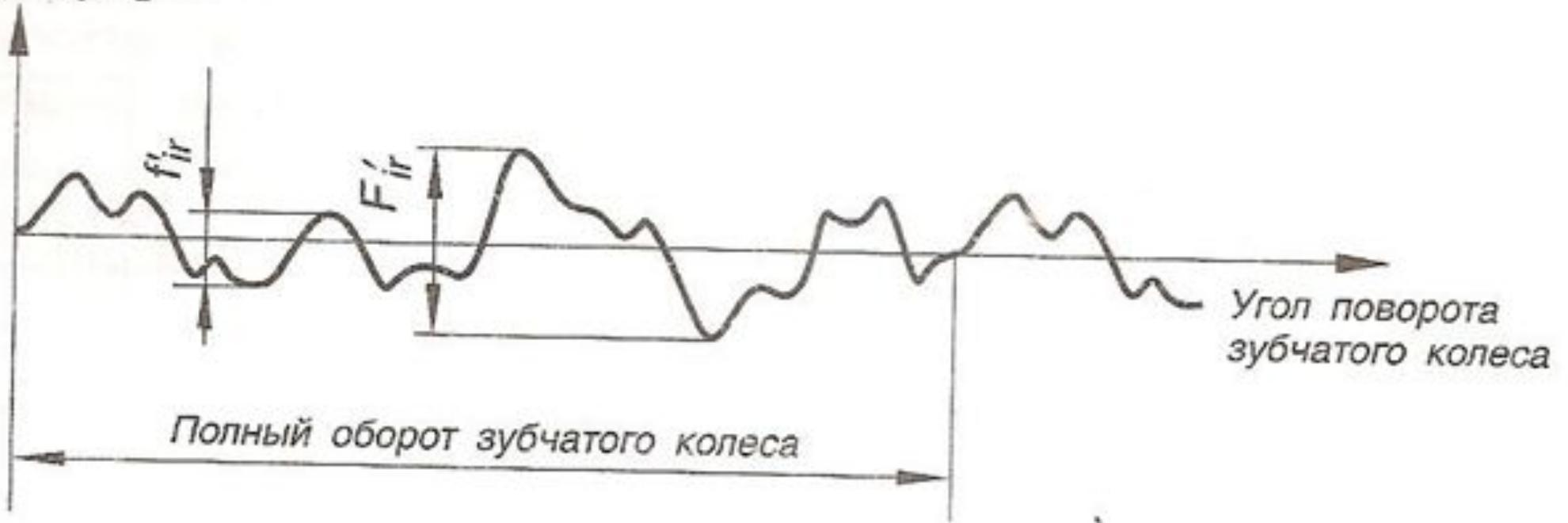
алгебраическая разность значений кинематической погрешности передачи за полный цикл измерения относительного положения зубчатых колес.
