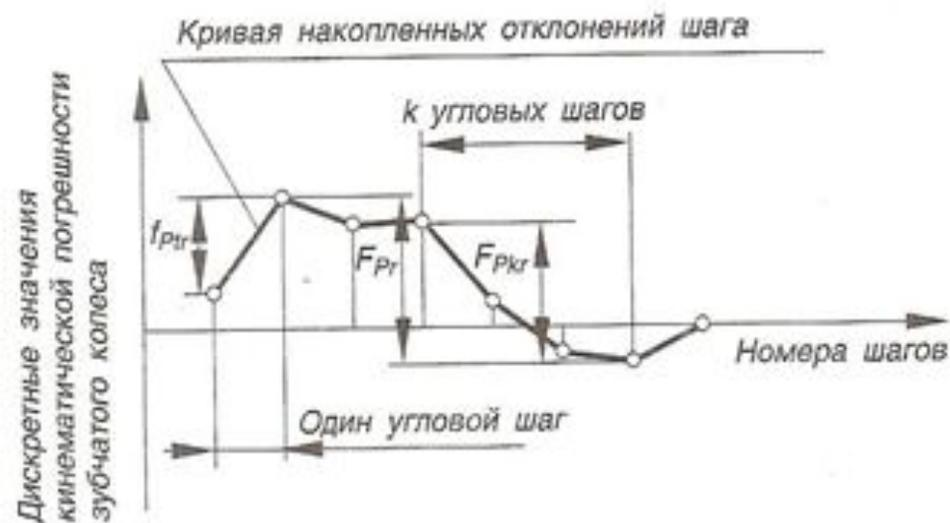
1. наибольшая кинематическая погрешность передачи  $F'_{ior}$  - наибольшая алгебраическая разность значений кинематической погрешности передачи за полный цикл измерения относительного положения зубчатых колес.
