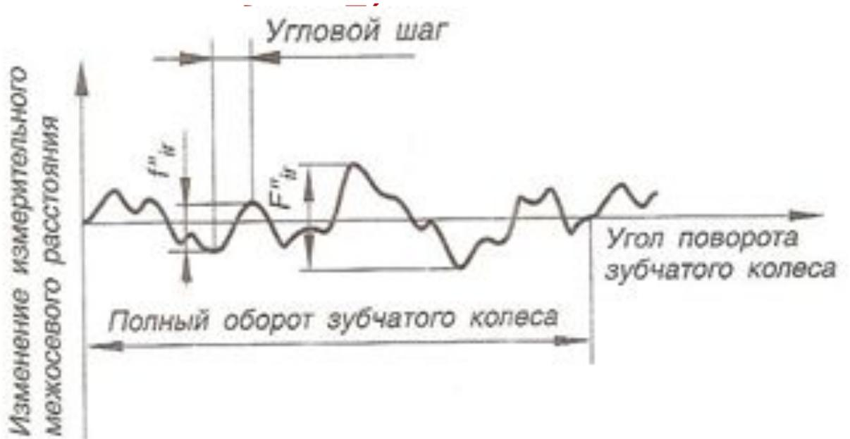
алгебраическая разность значений кинематической погрешности передачи за полный цикл измерения относительного положения зубчатых колес.
