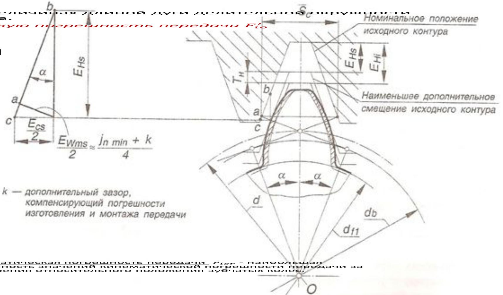
Выражается в линейных величинах длиной дуги делительной окружности ведомого зубчатого колеса.
