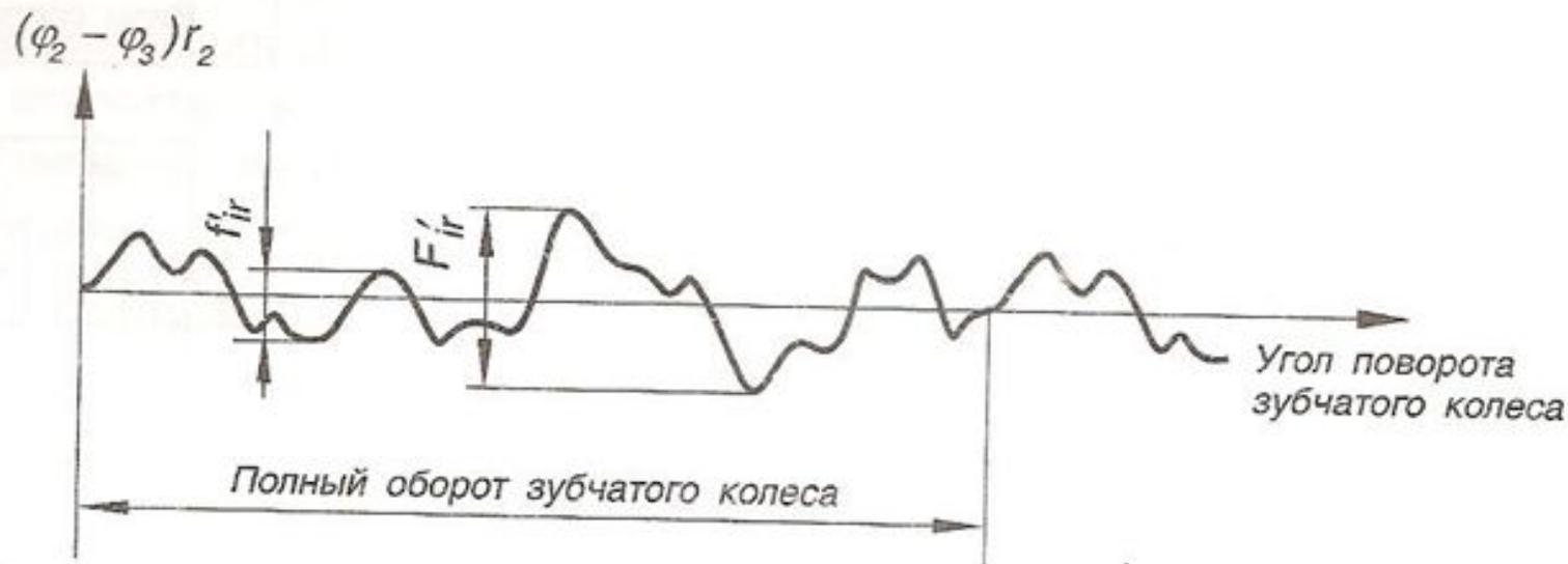
1. Наибольшая кинематическая погрешность передачи  $F'_{ior}$  - наибольшая алгебраическая разность значений кинематической погрешности передачи за полный цикл измерения относительного положения зубчатых колес.
