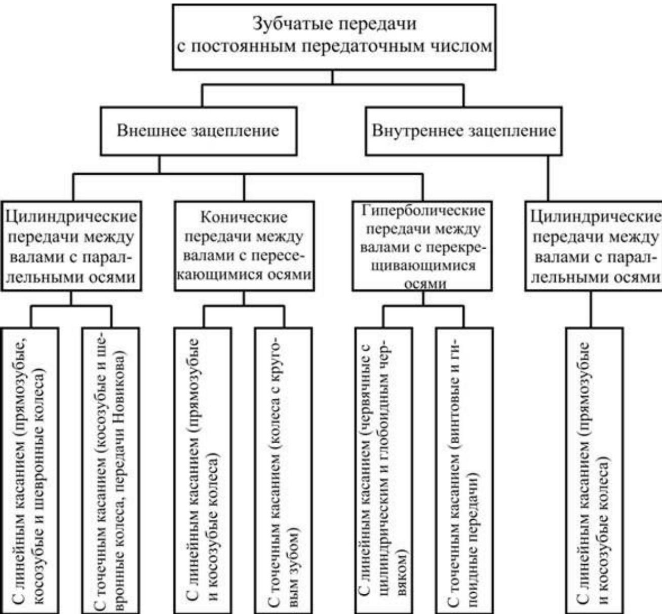
**1. По расположению осей колес в пространстве:** с параллельными осями (цилиндрические); с пересекающимися осями (конические); со скрещивающимися осями (червячные и винтовые).
