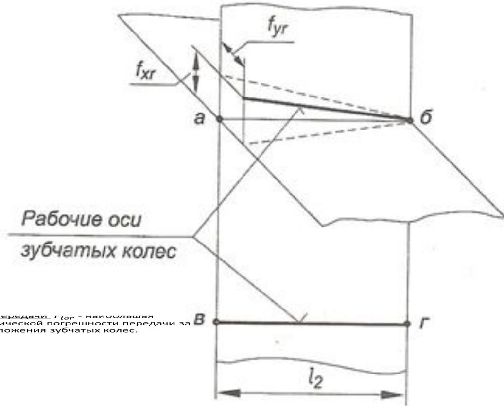
...  $f_{xr}$  - наибольшая кинематическая погрешность передачи,  $f_{yr}$  - наибольшая алгебраическая разность значений кинематической погрешности передачи за полный цикл измерения относительного положения зубчатых колес.
