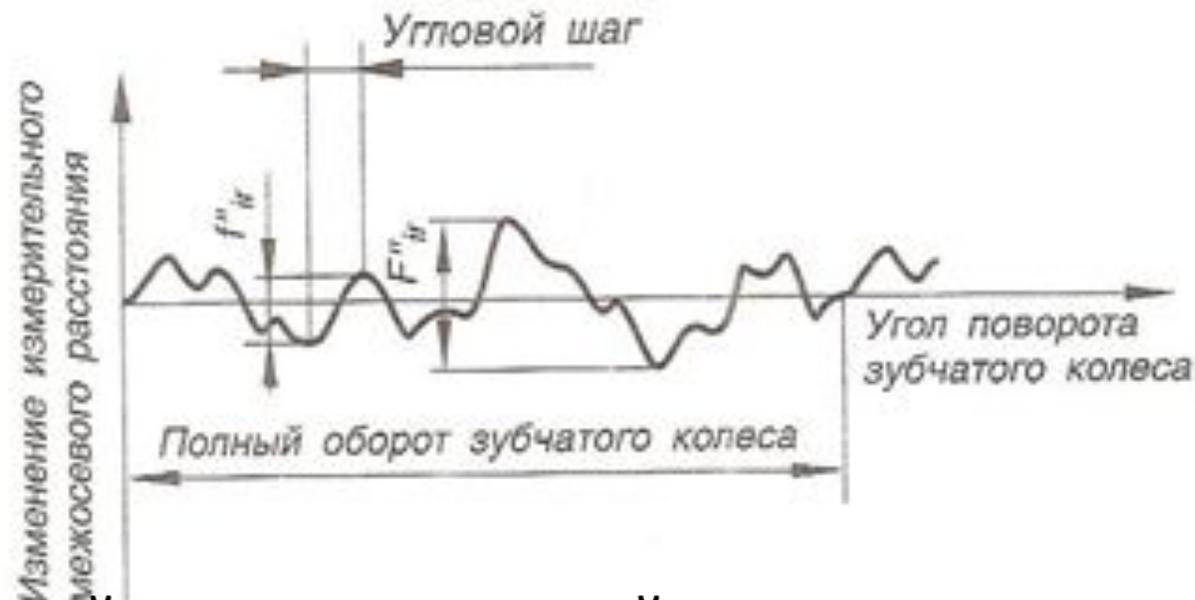
Выражается в линейных величинах длиной дуги делительной окружности алгебраическая разность значений кинематической погрешности передачи за полный цикл измерения относительного положения зубчатых колес.
