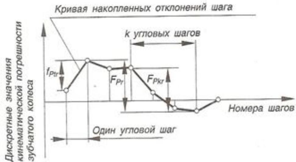
1. Наибольшая кинематическая погрешность передачи  $F_{iur}$  - наибольшая алгебраическая разность значений кинематической погрешности передачи за полный цикл измерения относительного положения зубчатых колес.
