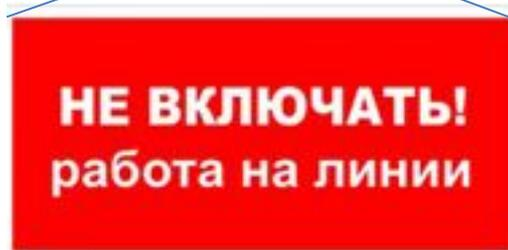
То же, но вывешивают на приводах, ключах и кнопках управления тех коммутационных аппаратов, при ошибочном включении которых может быть подано напряжение на воздушную или кабельную линию, на которой работают люди.
