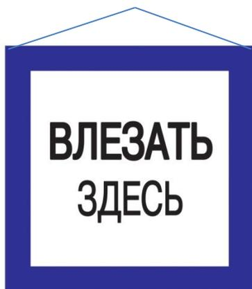
Вывешивают на конструкциях или стационарных лестницах, по которым разрешен подъем к расположенному на высоте рабочему месту
