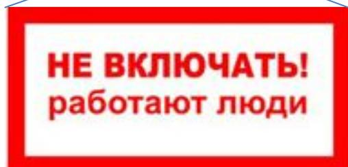
В электроустановках до и выше 1000 В вывешивают на приводах разъединителей и выключателей нагрузки, на ключах и кнопках дистанционного управления, на коммутационной аппаратуре до 1000 В (автоматах, рубильниках, выключателях)
