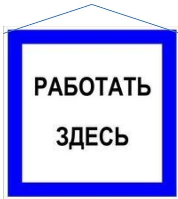
В электроустановках электростанций и подстанций. Вывешивают на рабочем месте. В ОРУ при наличии защитных ограждений рабочего места вывешивают в месте прохода за ограждение
