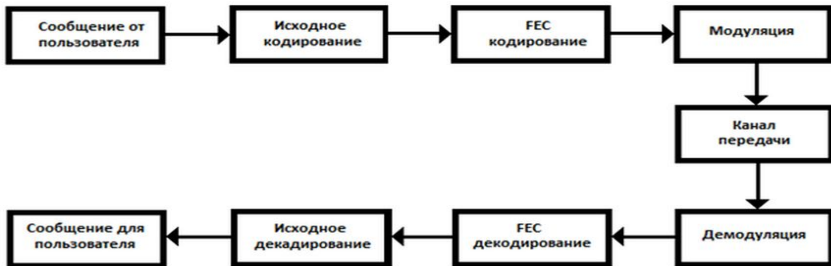
БЛОК СХЕМА ИНФОРМАЦИОННЫХ ПОТОКОВ В ЦИФРОВЫХ СИСТЕМАХ СВЯЗИ
