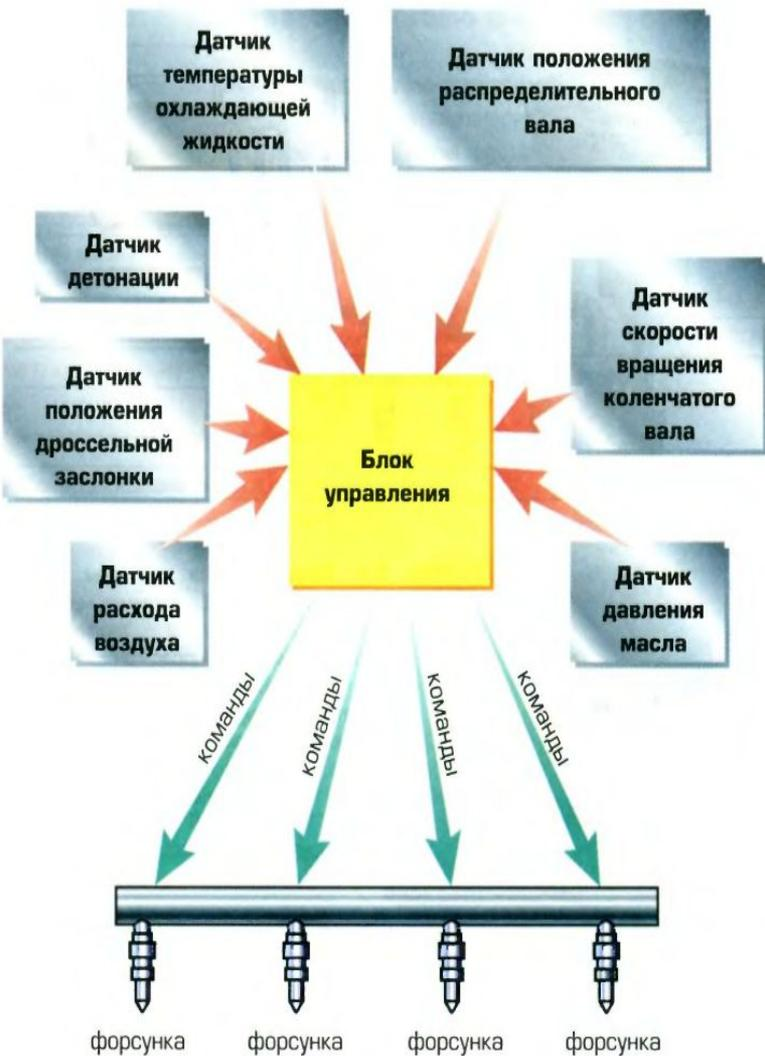
Рис. 20. Принцип работы бортового компьютера.
