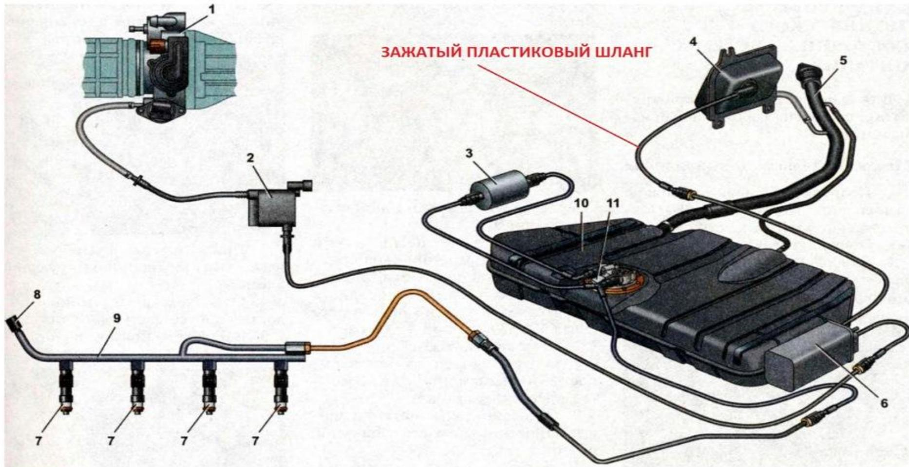
Схема системы питания двигателя: 1 — дроссельный узел; 2 — клапан продувки адсорбера; 3 — топливный фильтр; 4 — сепаратор; 5 — заливная труба; 6 — адсорбер; 7 — форсунки; 8 — диагностический штуцер топливной рампы; 9 — топливная раampa; 10 — топливный бак; 11 — топливный модуль
