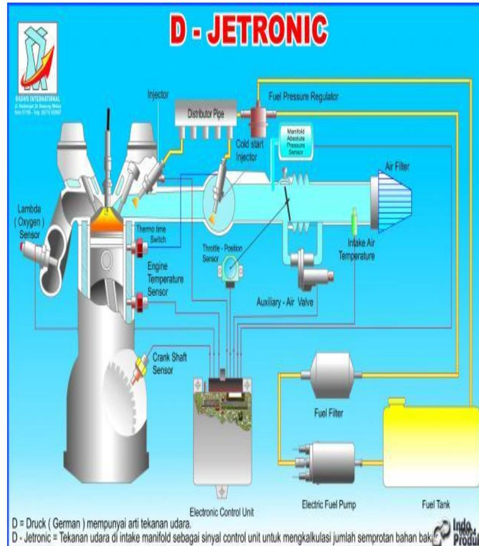
В середине 1970-х ввиду низкой надёжности аналоговых модулей управления, на некорректную работу **D-Jetronic** приходилось подавляющая часть обращений в сервис, была практически вытеснена из крупносерийного автомобилестроения. Сама же идея электронно-управляемой СBT на основе датчика абсолютного давления была реализована Bosch в 2000-х годах
