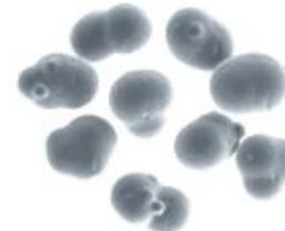
Кремниевые микрошеры (40 мкм) с использованием изотопа  $^{32}\text{P}$
