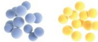
Стеклянные и полимерные микрошеры (40 мкм) с использованием изотопа  $^{90}\text{Y}$
