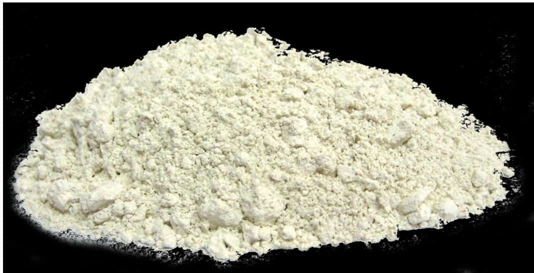
● Гипсовые вяжущие широко применяются в строительной индустрии. Их добавляют в известково-песчаные растворы для ускорения схватывания и увеличения прочности.
