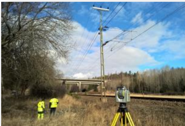
Проверка провесов проводов ЛЭП
