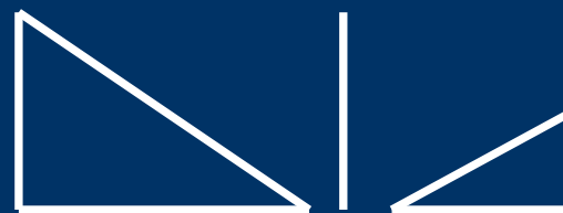
АМ с несущей, одной боковой и частично погашенной второй
