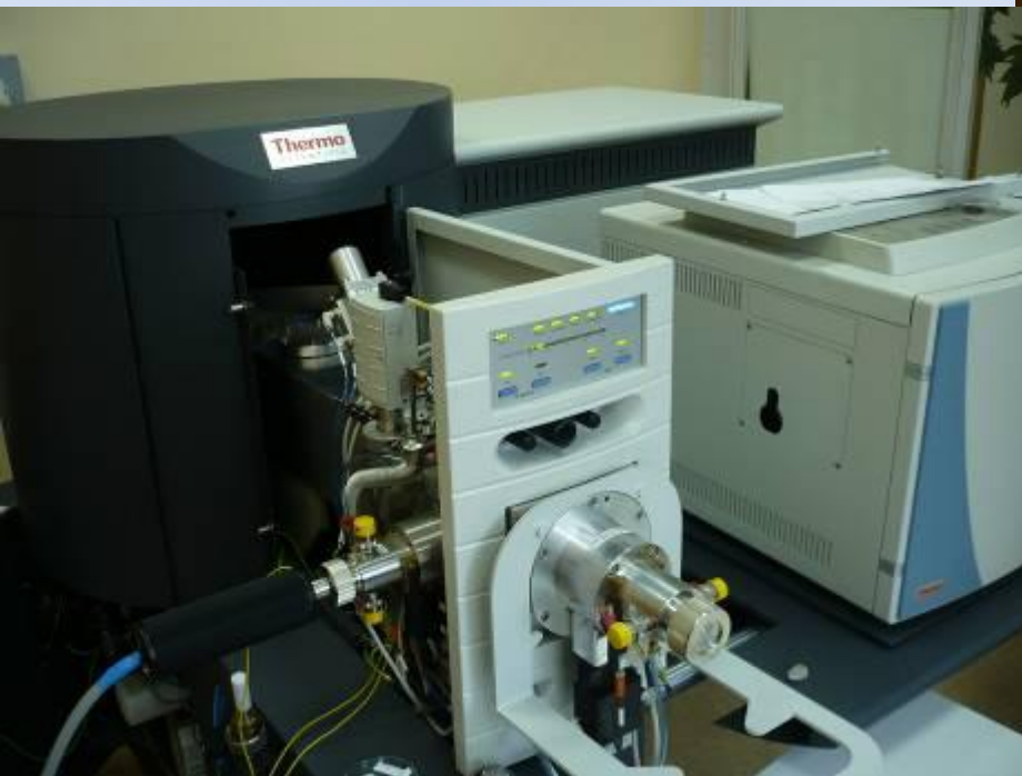
Рис. Масс-спектрометр высокого разрешения Thermo Electron DFS с газовым хроматографом Thermo Electron Trace GC Ultra
