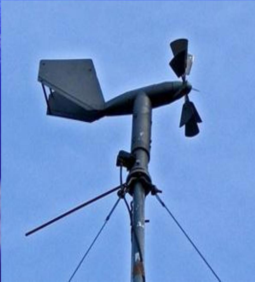
Силу и направление ветра определяют анеморумбометром. Он состоит из флюгера (похожий на самолет предмет, поворачивающийся в направлении ветра) и датчика. Направление ветра обозначается на датчике в румбах, а сила - в метрах в секунду.
