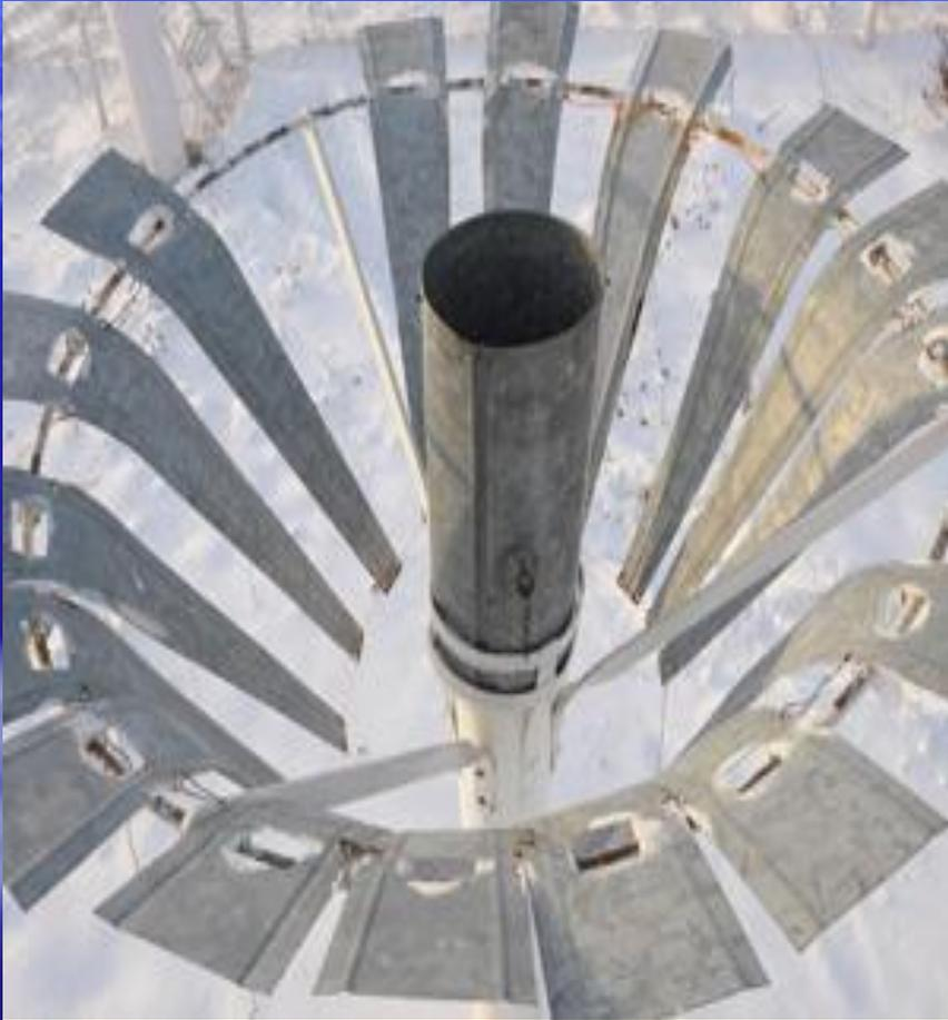
Определение уровня осадков ведется с помощью осадкомера. Это оцинкованное ведро с носиком. Снег (град) набранный за 3 часа растапливается и сливается через носик в осадкомерный стакан.
