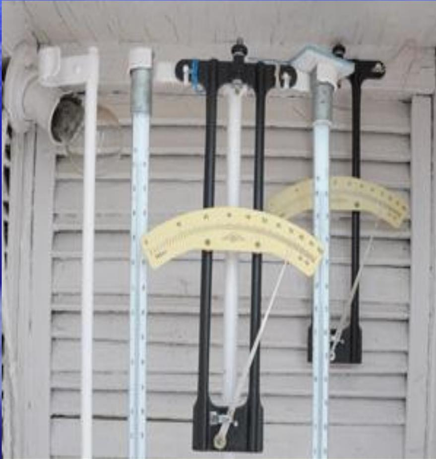
Температура воздуха измеряется термометрами, которые находятся в психрометрической будке в 2 метрах от земли.
