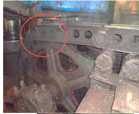
В 3:00 произошла остановка конвейера, по причине набегания левой цепи на приводную звездочку, из-за выработки пальцев и звеньев цепи. В 3:24 конвейер отдали в работу.
