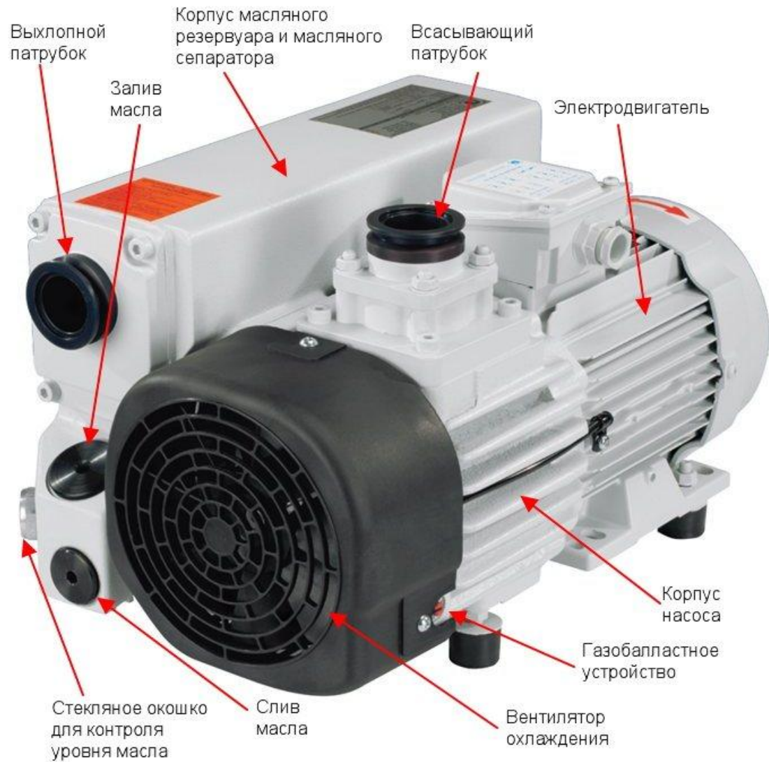
Изображение 1. Основные элементы пластинчато-роторного вакуумного насоса на примере модели «Leybold Sogevac»
