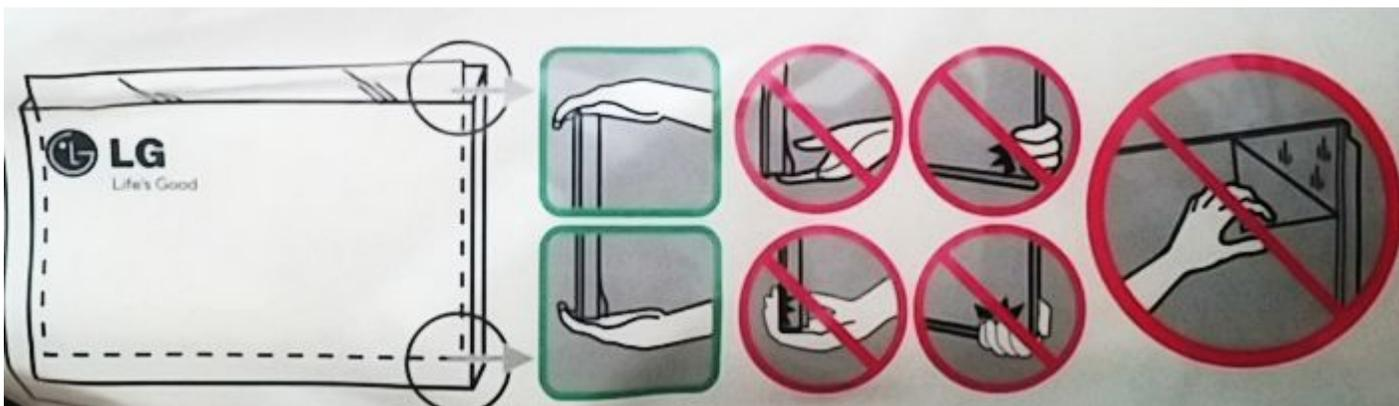
Предотвращение повреждений LCD модуля
