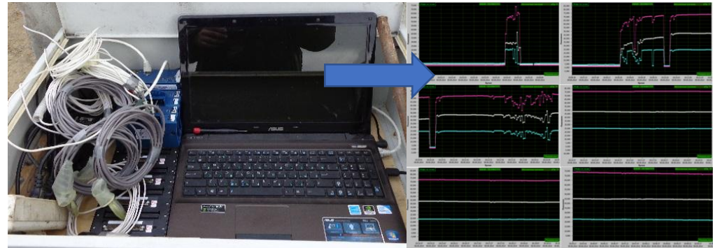
Релаксация напряжений после инъекции раствора в мембрану-стакан
