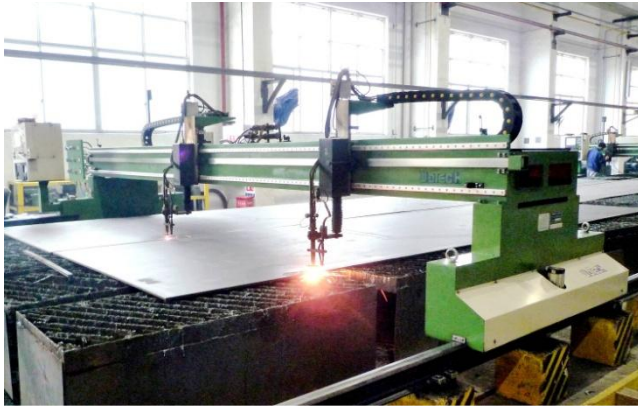
Shanghai “Esab” NC flame cutting machine Машина газопламенной резки (шанхай “Esab”)
