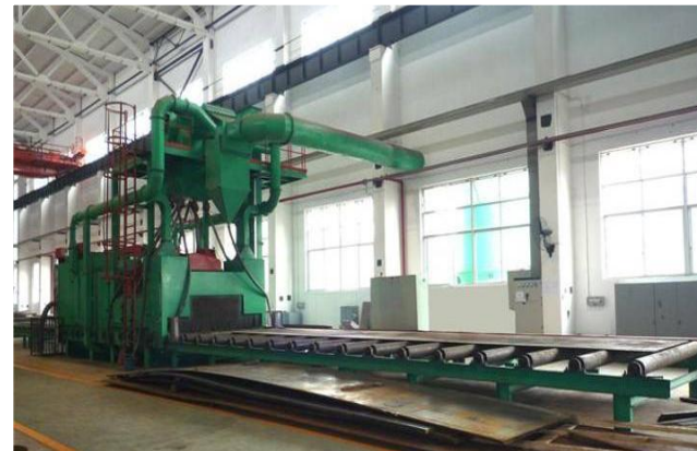
Large blaster equipment крупногабаритная дробеструйная машина
