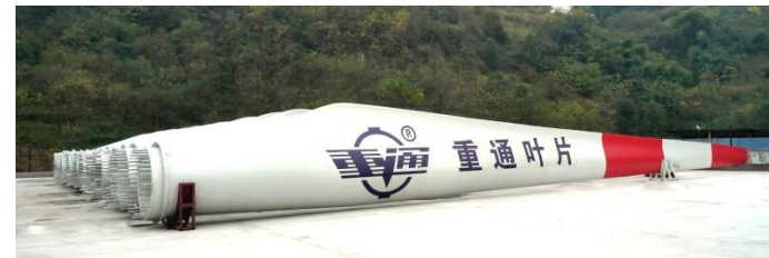
2MW wind power turbine blades 2 мега ваттные лопасти ветровых турбин
