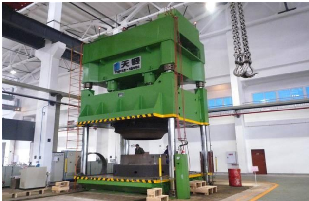
4-column Oil Press machine, 1200 tons 4-х колонный гидравлический пресс, 1200 ТОНН
