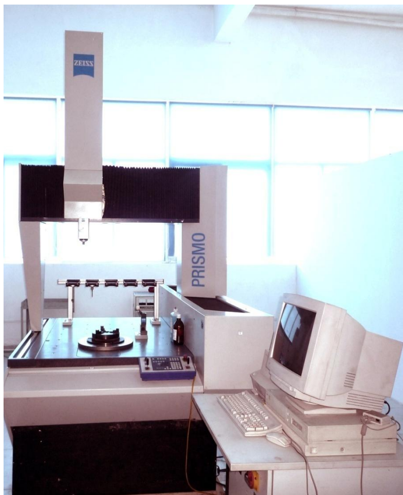
Carl Zeiss 4-axis Coordinate Measuring Machine Carl Zeiss ( германия) 4-х осевая координатно измерительная машина
