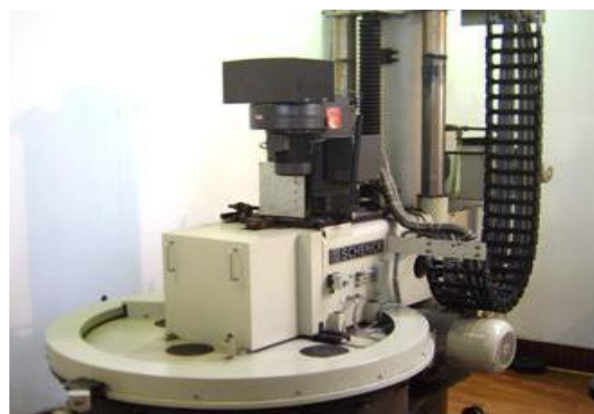
Schenck Spin Test Stand Шенк Ротек (германия) вакуумная испытательная машина
