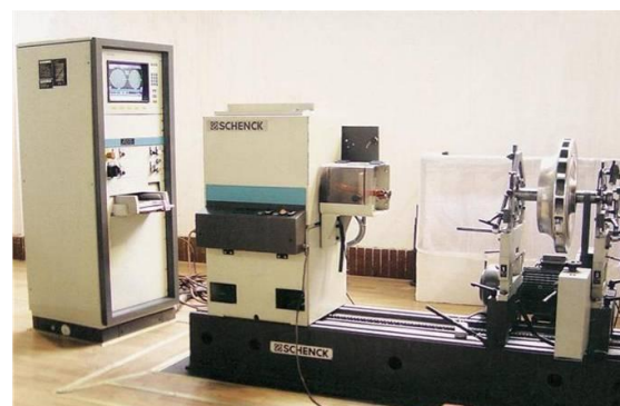
Schenck Dynamic Balancing Test Stand Шенк Ротек (германия) высокоточная балансировочная машина
