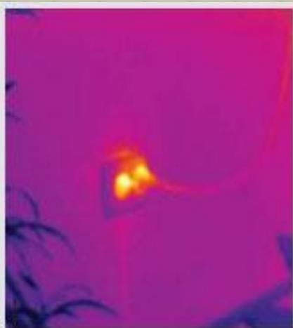
Рис. 10. Перегруженная розетка
