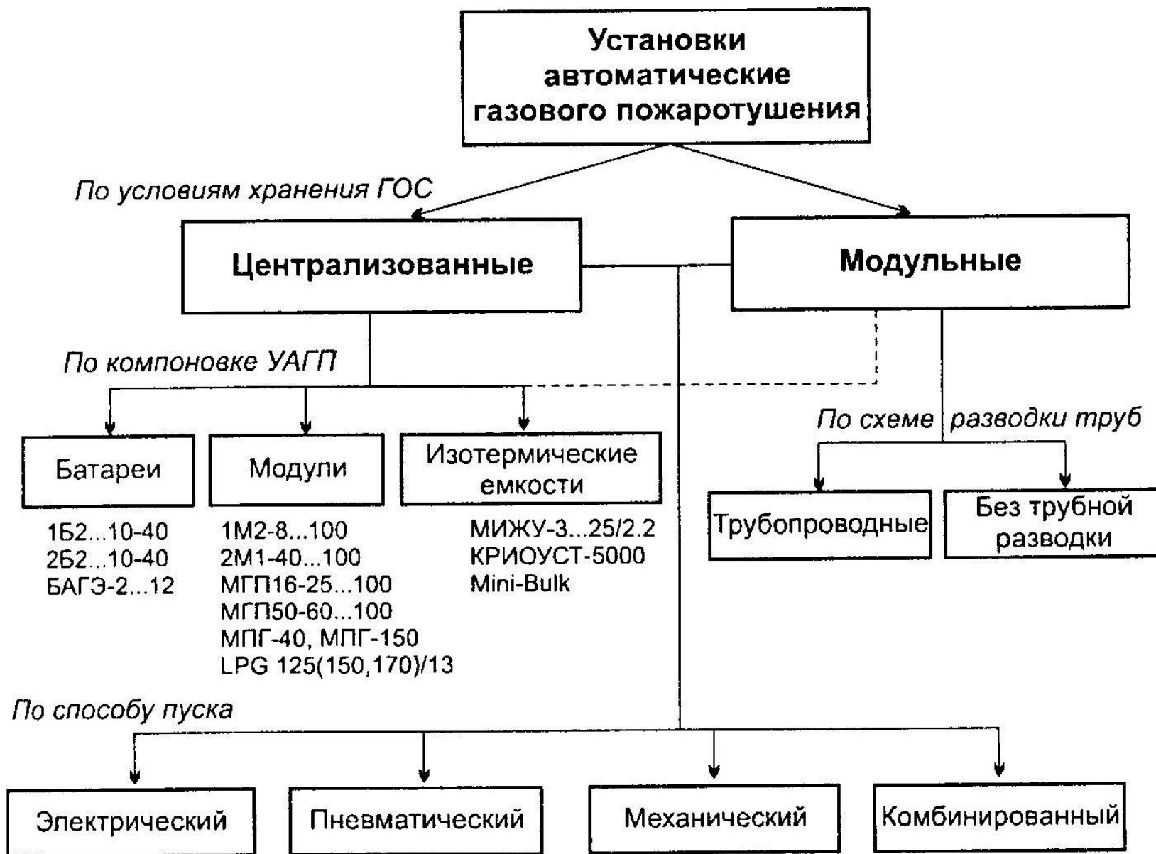
Рис. 3.1.1. Классификация автоматических установок газового пожаротушения
