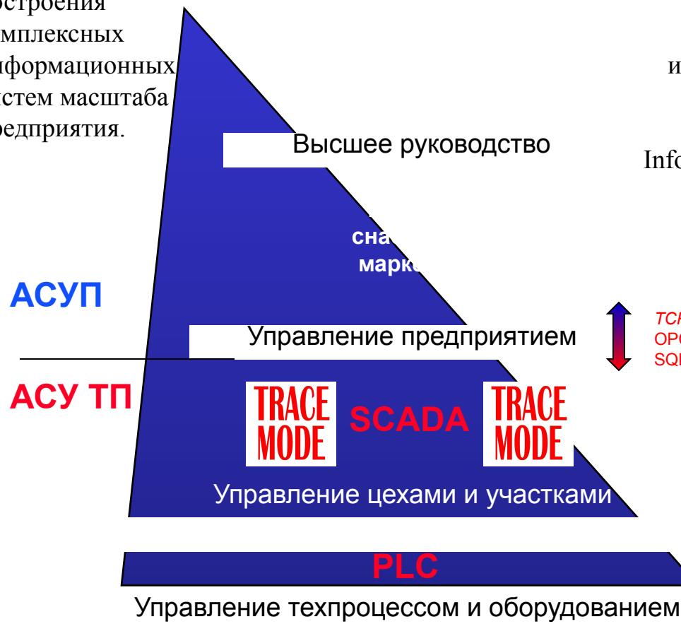
Благодаря поддержке DCOM, OPC, ActiveX, SQL/ODBC и DDE, ТРЕЙС МОУД обеспечивает простую интеграцию в информационные системы АСУП, на базе ведущих СУБД (например Oracle, Informix, Sybase, SQL Server, Access и др.).
