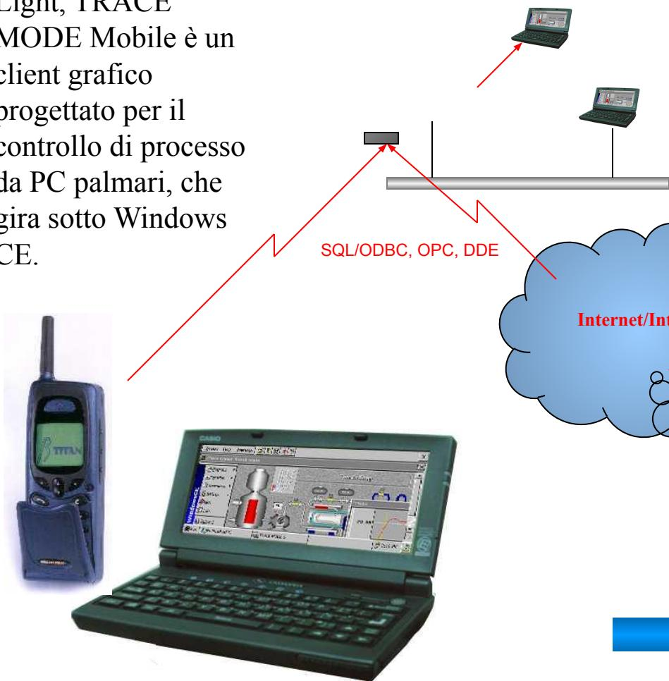
Trace Mode Mobile può connettersi con RTM attraverso il sistema **GSM**, Internet, porta infrarossi, reti, RS-232/485 o con il modem tramite protocollo TCP/IP.
