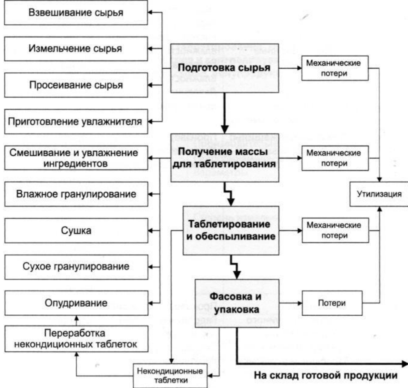
Рис. 4.17. Унифицированная технологическая схема производства таблеток без покрытия
