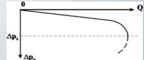
Вид индикаторной кривой при фильтрации несжимаемой жидкости в трещиноватом пласте
