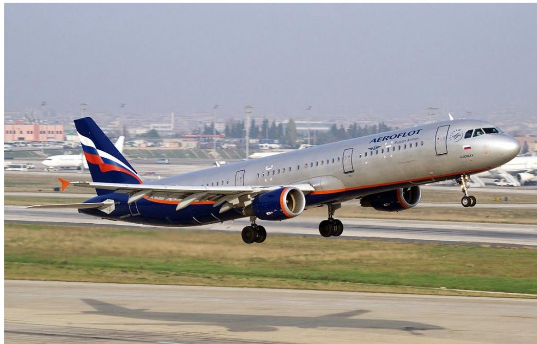
Не сложно догадаться что А321 удлиненная версия А320. Главное отличие А321 от других самолетов семейства — это отсутствие аварийных выходов на плоскость крыла в виде люков. Вместо них — полноразмерные двери перед и за крылом, оборудованные полноценными надувными трапами. Видите с каждой стороны по четыре больших двери на практически равном расстоянии друг от друга? Это А321.
