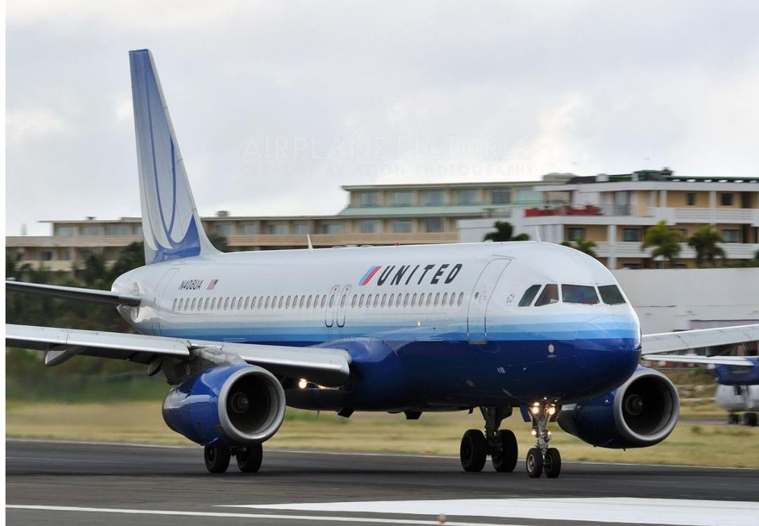
A320 - базовая версия. Как же все-таки отличить A320? Очень просто: посчитать аварийные выходы на плоскость крыла. Если их с каждой стороны по два — скорее всего, перед вами A320. Почему «скорее всего»? Потому что есть редкие исключения из этого правила, но потерпите немножко.
