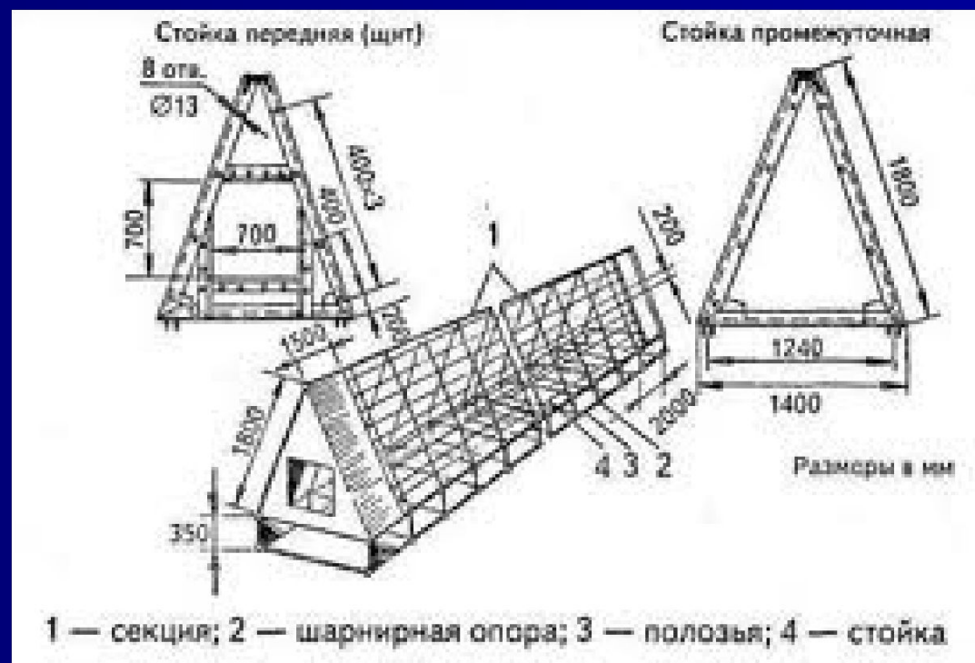
Воздухораспределитель для сушки сена
