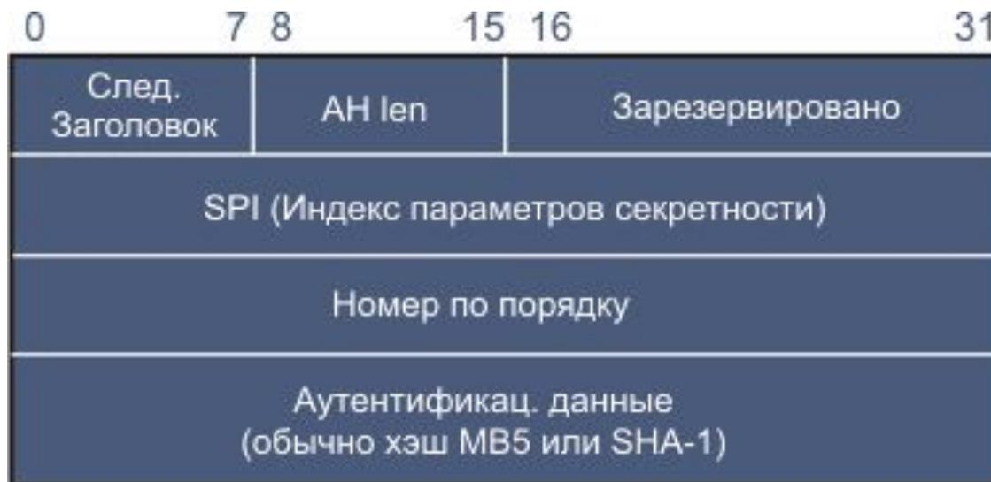
Рис. 15. Формат заголовка протокола АН
