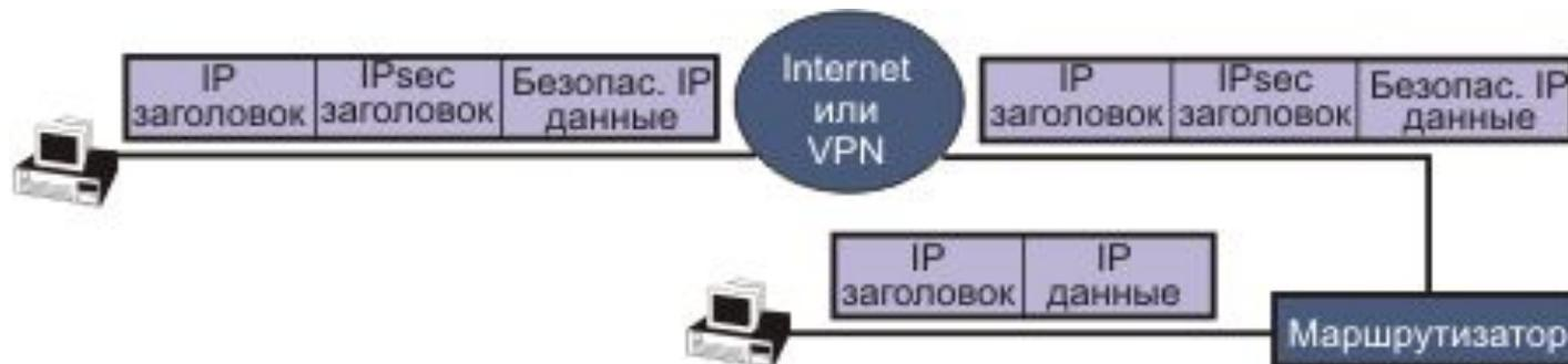
Рис. 14. Общая схема преобразования данных в IPsec
