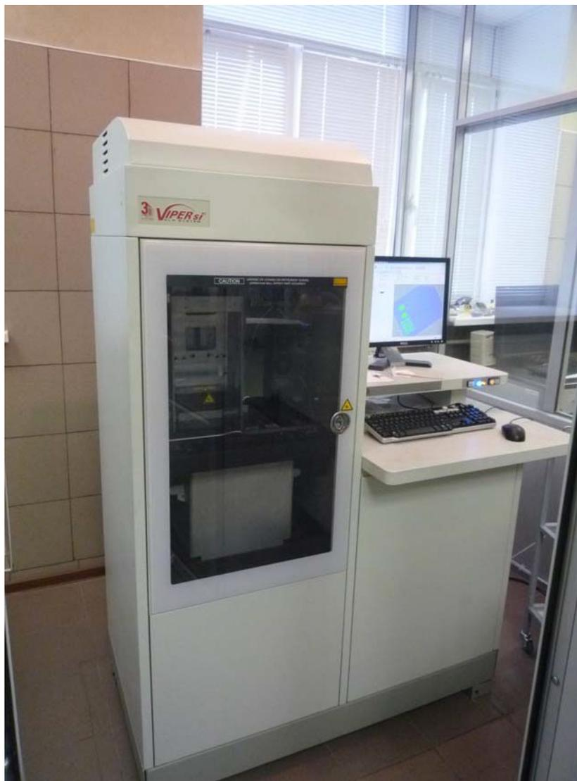
Рис. 2.17. Стереолитографическая система *Viper si2TM*
