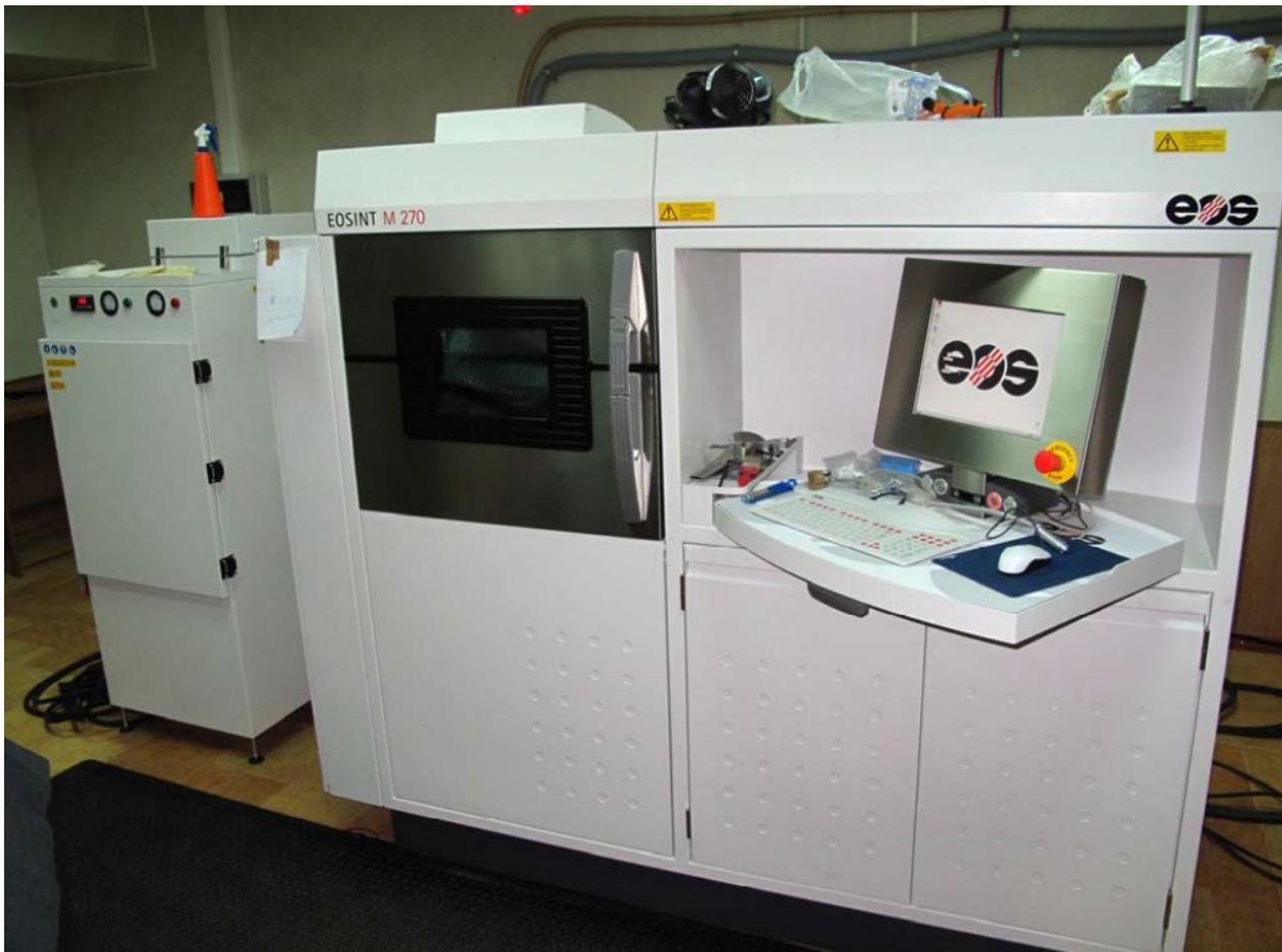
Установка для лазерного спекания *EOSINT M 270*
