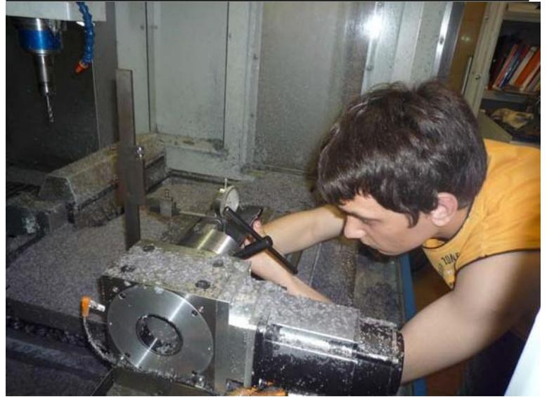
Процесс изготовления деталей на станке *Profi Speed 600*
