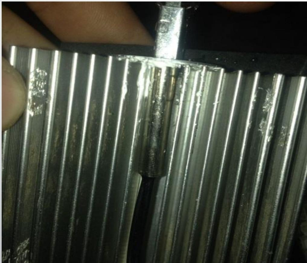
После установки датчика в радиатор, на радиатор устанавливается кулер для охлаждения лампы накаливания.
