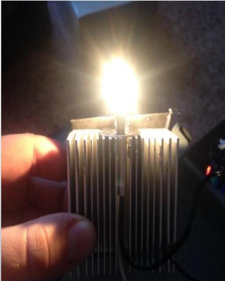
После установки к радиатору лампы накаливания, к лампе устанавливается датчик тепла, который идет от терморегулятора.
