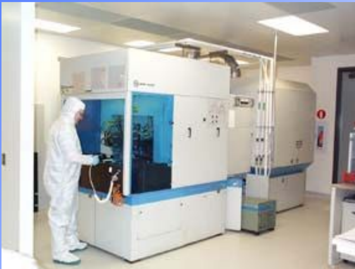
Varian 350D ionimplanter, 4 és 6 inches szeletekhez
