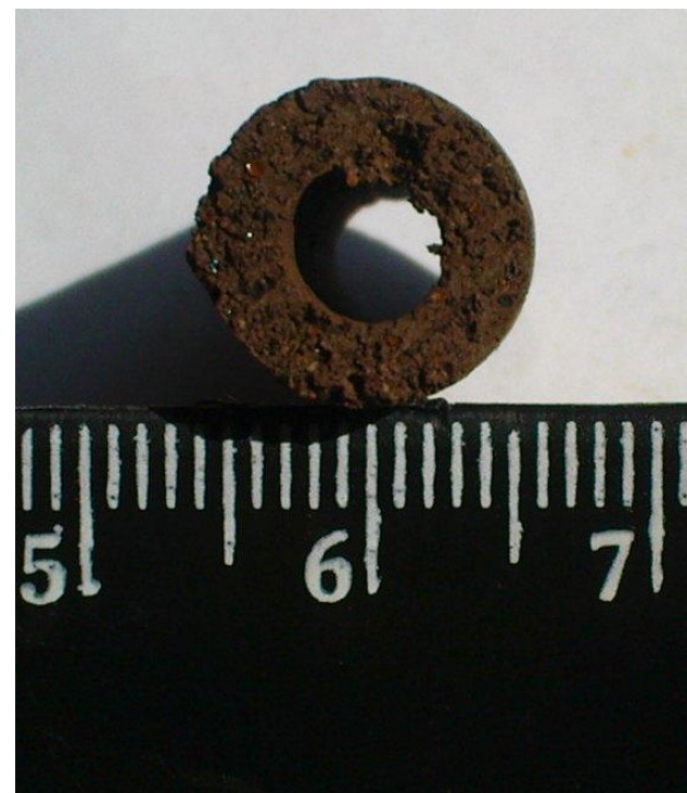
трубчатый катализатор ( d_{\text{вн}}=5\text{мм} , h=30\text{мм} , \delta=2\text{мм} )
