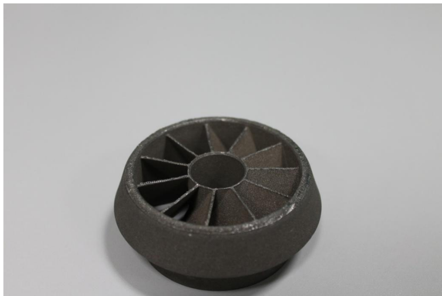
Завихритель из нержавеющей стали РН1
