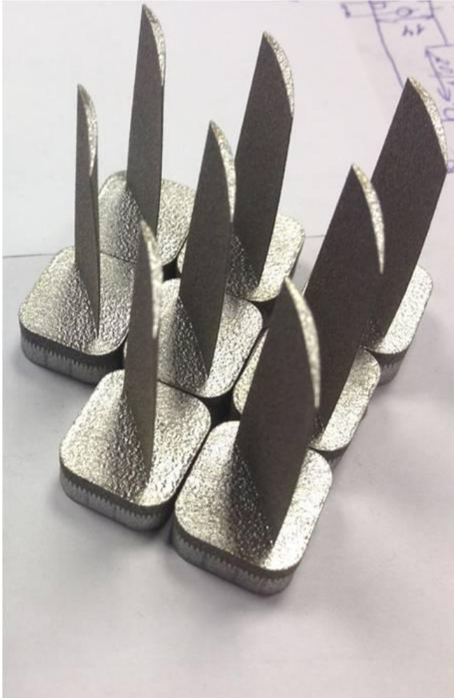
Лопатки направляющего аппарата из нержавеющей стали марки РН1
