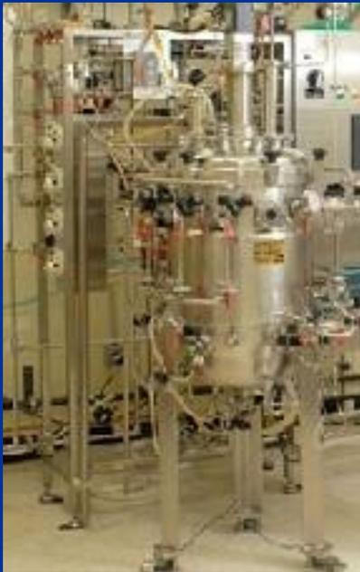
В биореакторе непрерывного действия обеспечивается **стабилизация культуры микроорганизмов на стадии активного биосинтеза** при непрерывном добавлении питательной среды и непрерывном отборе готовой культуры.
