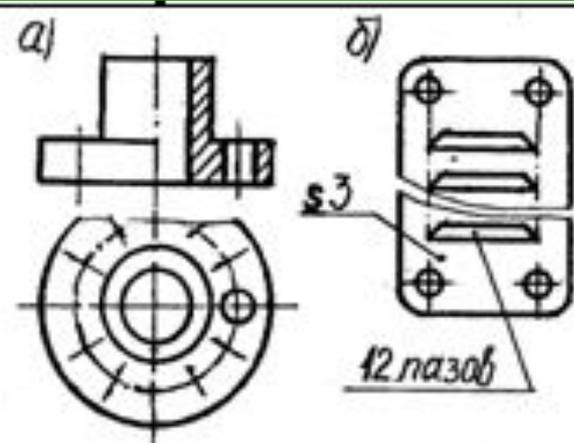
6. На чертежах деталей накатку и насечку рекомендуется изображать частично с возможным упрощением. Расстояние между линиями накатки выдерживается постоянным.
