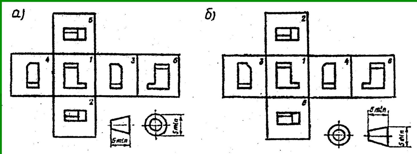
Совмещенное положение плоскостей проекций в одну плоскость с видом спереди (главным видом) при методах Е (а) и А (б)
