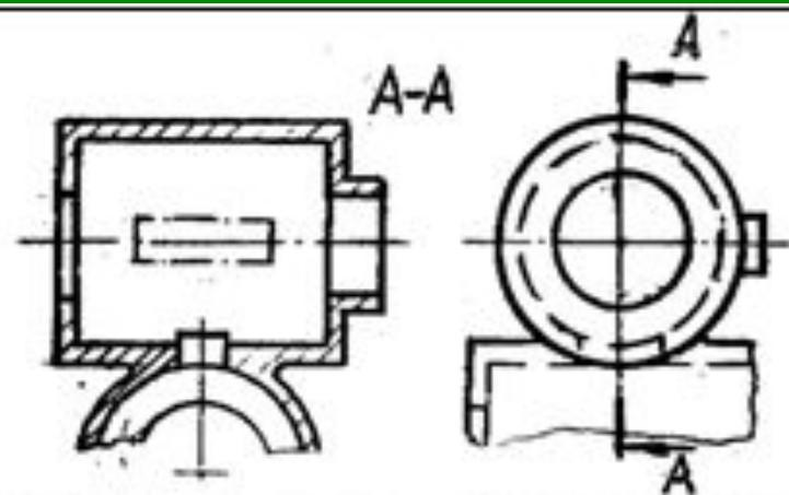
12. Отверстия, расположенные по окружности в круглых фланцах и не попадающие в секущую плоскость, условно показываются в разрезе. При этом отверстия проектируются после совмещения с секущей плоскостью.
