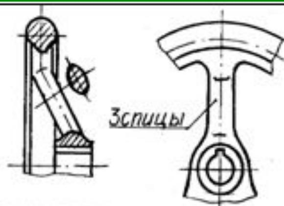
8. Длинные детали, или элементы деталей, имеющие постоянное или закономерно изменяющееся поперечное сечение (валы, прутки, фасонный прокат, шатуны), допускается изображать с разрывом.
