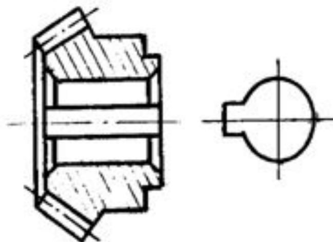
5. Если деталь имеет несколько одинаковых, равномерно расположенных элементов, например, отверстий, пазов, зубьев, то на чертеже этой детали рекомендуется полностью изображать один-два таких элемента, а остальные показывать упрощенно или условно.
