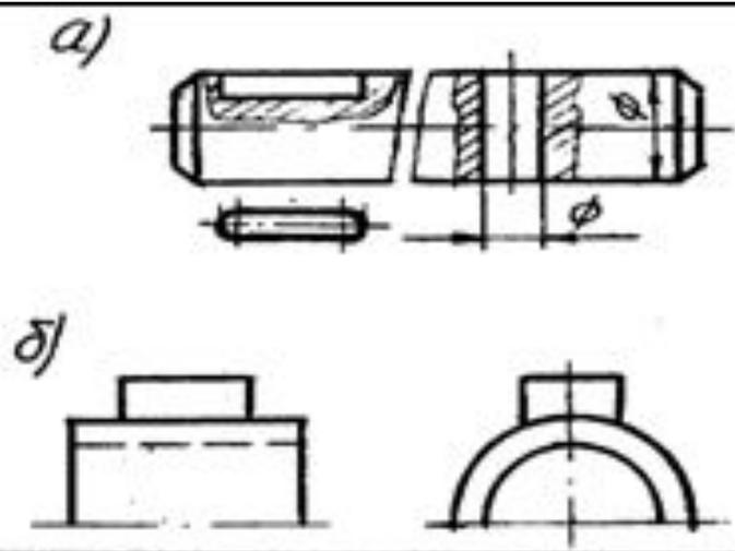
11. Допускается изображать штрихпунктирной утолщенной линией элементы деталей, находящиеся между наблюдателем и секущей плоскостью (наложенные проекции).
