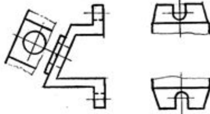
4. Для показа отверстий в ступицах колес, шкивов и т.д. вместо второго изображения детали рекомендуется давать лишь контур отверстия.
