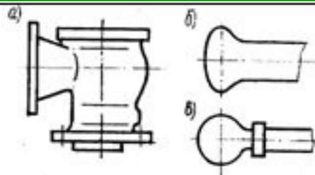
10. Для показа пересечений прямоугольных, цилиндрических, конических и т.д. отверстий с цилиндрической поверхностью допускаются упрощения, показанные на примерах.
