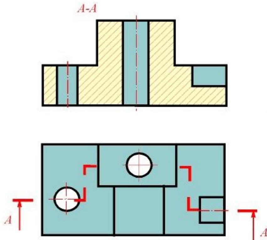
Сложными ступенчатыми называются разрезы при нескольких секущих параллельных плоскостях
