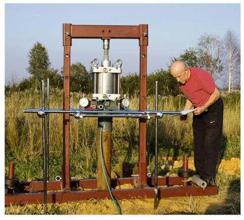
Испытания грунтов винтовым штампом
