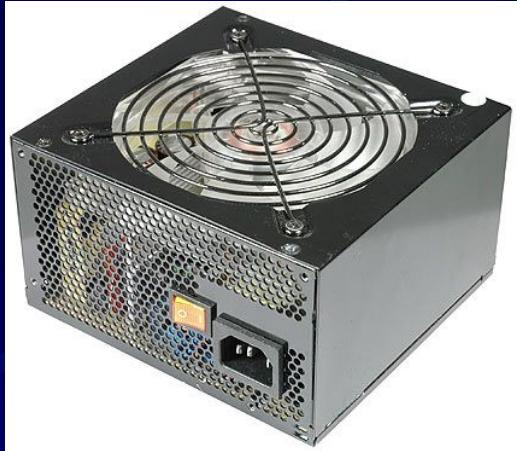
Отримує напругу з загальної мережі струму (~220 v), понижує її та випрямляє до -5v та -12v і розподіляє по споживачам (пристроям) які знаходяться в системному блоці.
