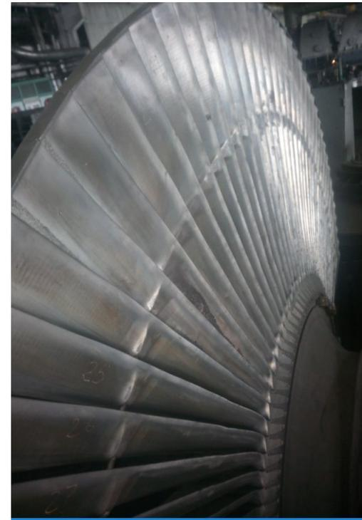
Рабочие лопатки 5-х ступеней ЦНД с цельнофрезерованным бандажом (черт. Б-482-20-23, Б-482-20-14) длиной 1030 мм и диафрагмы (черт. Б-822-65-(01) СБА, Б-822-75-(01) СБА) длиной 1000 мм устанавливаются вместо ступени с рабочей лопаткой 1050 мм с трубчатым бандажом, без необходимости доработки других элементов конструкции турбины.
