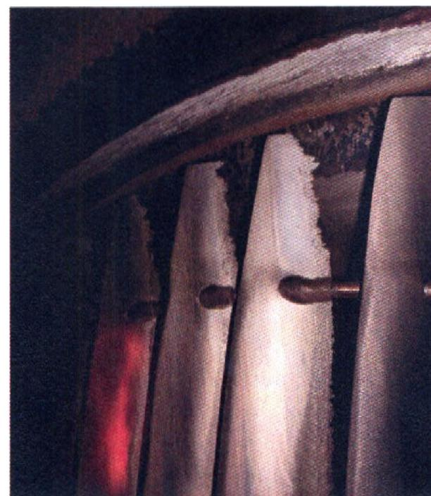
Так же в процессе эксплуатации лопаток с трубчатым бандажом 5-х ступеней при осмотре наблюдаются частые обрывы бандажей по 4÷5 шт. в месяц на каждой ступени, большое количество обрывов бандажей негативно влияет на состояние вибрации подшипников ТГ.
