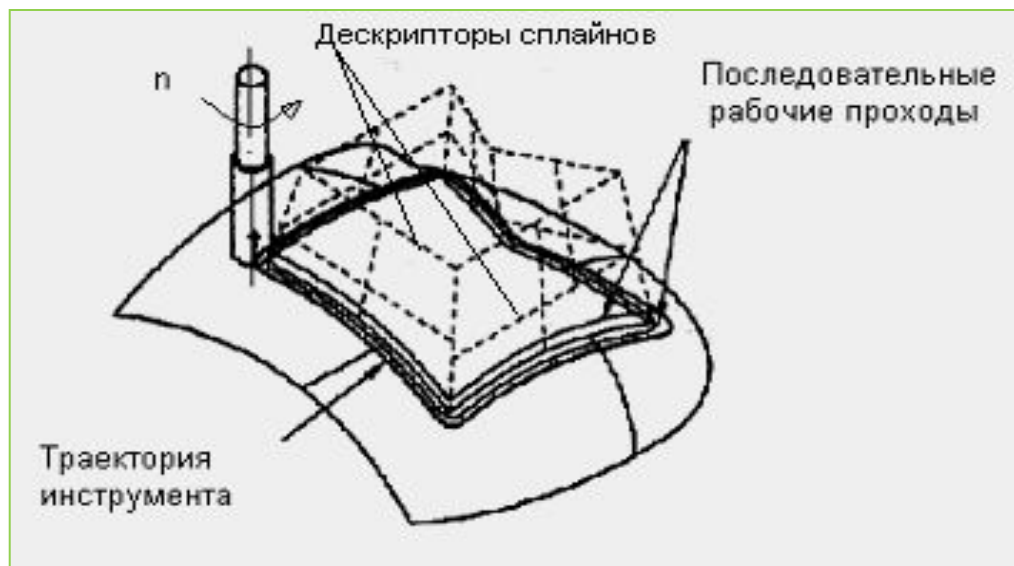
Схема послойного чернового фрезерования рельефной поверхности методом сплайновой интерполяции
