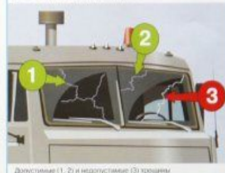
Допустимые (1, 2) и недопустимые (3) трещины
