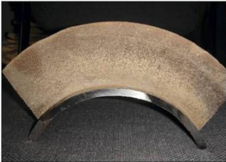
Рис. 1. Образец теплопровода в ППМ изоляции, находившийся в эксплуатации 21 год.
