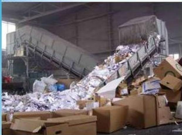
**В процессе переработки макулатура, газеты, журналы, картон, а также бумажные отходы измельчаются и отбеливаются для того, что - бы удалить краску и грязь, потом смешивается с водой и перемалываются до состояния бумажной массы.**
