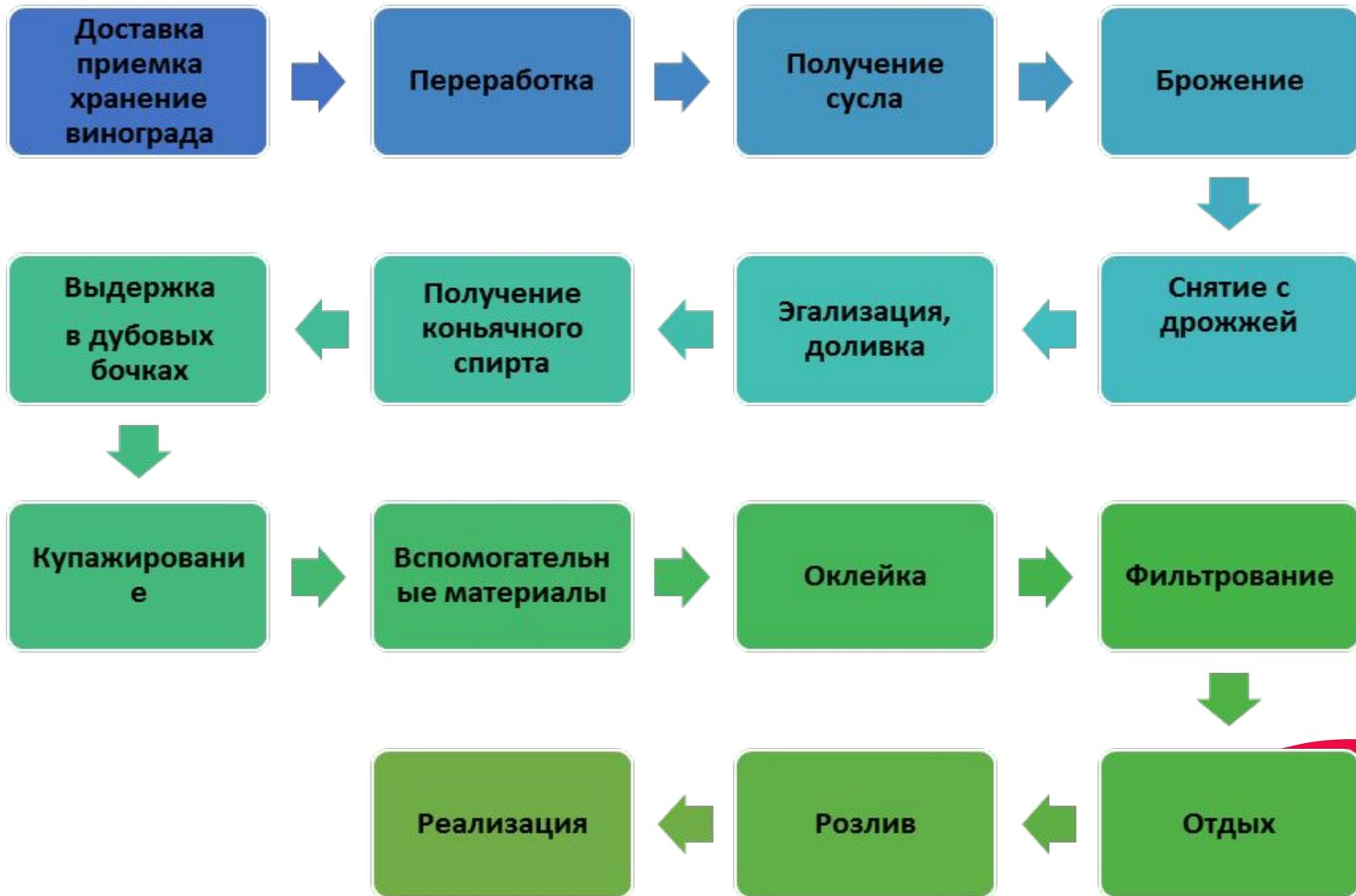
Рис.1 Аппаратурно-технологическая схема производства коньяка
