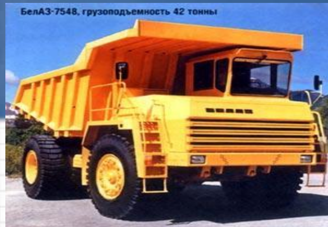
БелАЗ-7548, грузоподъемность 42 тонны
