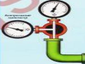
Рабочий манометр соединить с контрольным и проверить правильность показаний рабочего манометра
