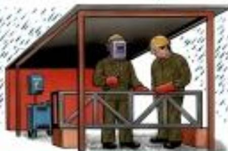
ПРАВИЛЬНО ПОДКЛЮЧАЙТЕ К СЕТИ СВАРОЧНОЕ ОБОРУДОВАНИЕ (разрешается электрику с группой электробезопасности не ниже III)
