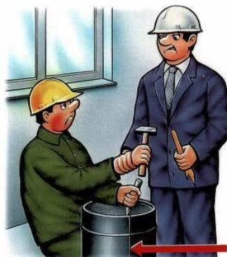
Для вскрытия барабана с карбидом кальция запрещено использовать искрообразующий инструмент! Применяйте только специальный нож
