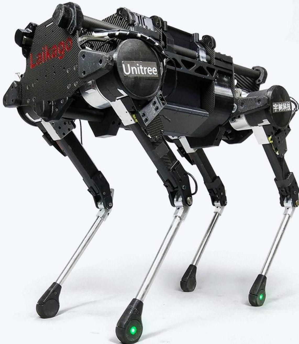
И всё равно такому роботу, как тот, что вы видите перед собой, необходимы гироскопические датчики и компьютер, который на основании их показаний будет регулировать работу всех ног таким образом, чтобы робот не упал, так как его ноги не имеют широкого основания, чтобы распределить центра тяжести на большую площадь.
