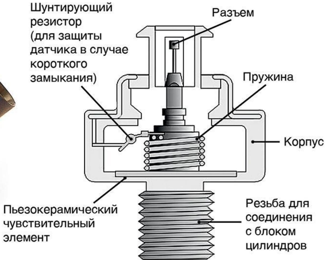
Опишите назначение устройство и принцип работы датчика детонации в микропроцессорной системе зажигания
