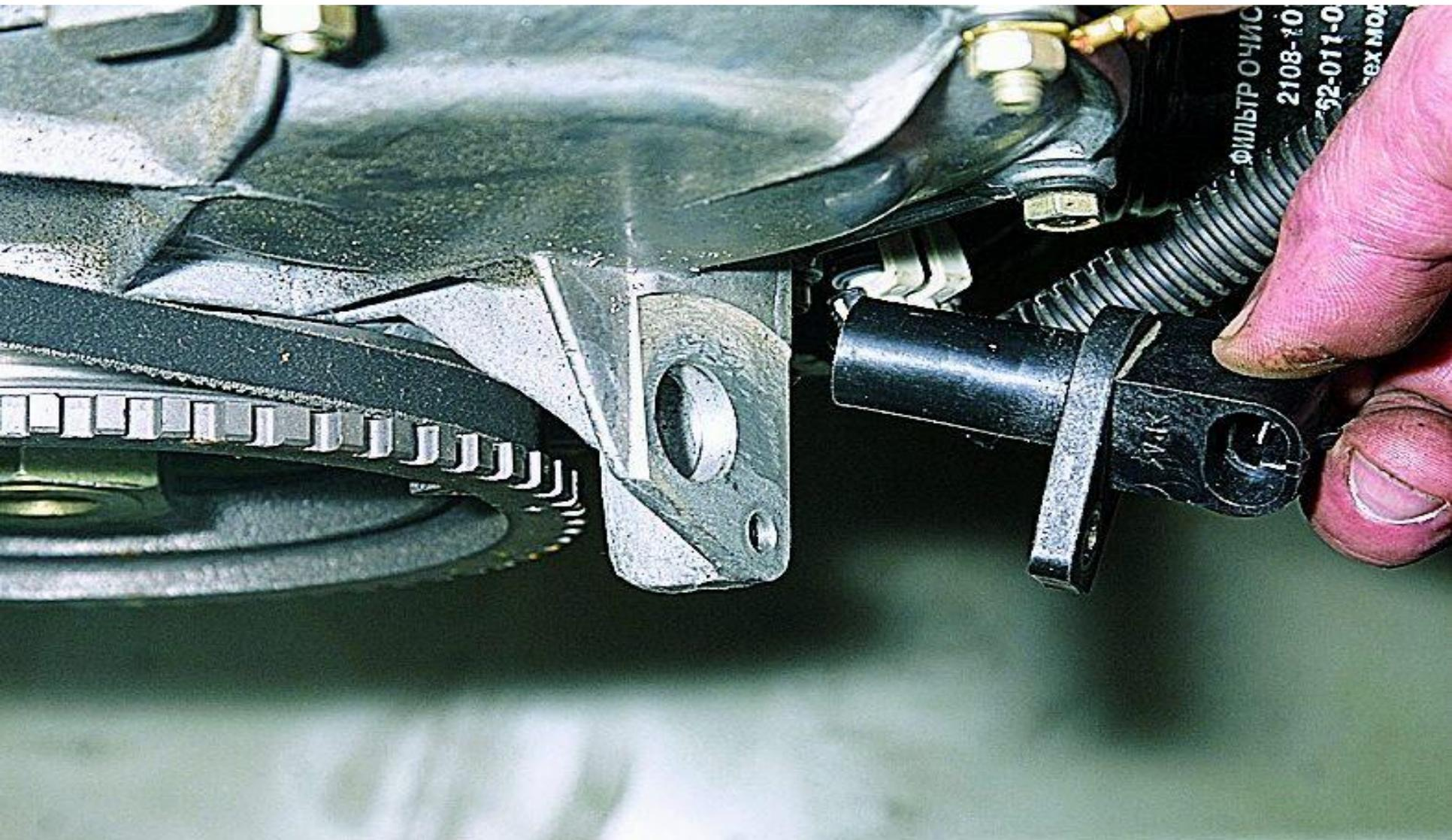
Опишите назначение датчика положения коленвала
