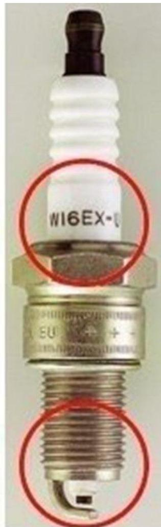
Поддельная свеча зажигания
