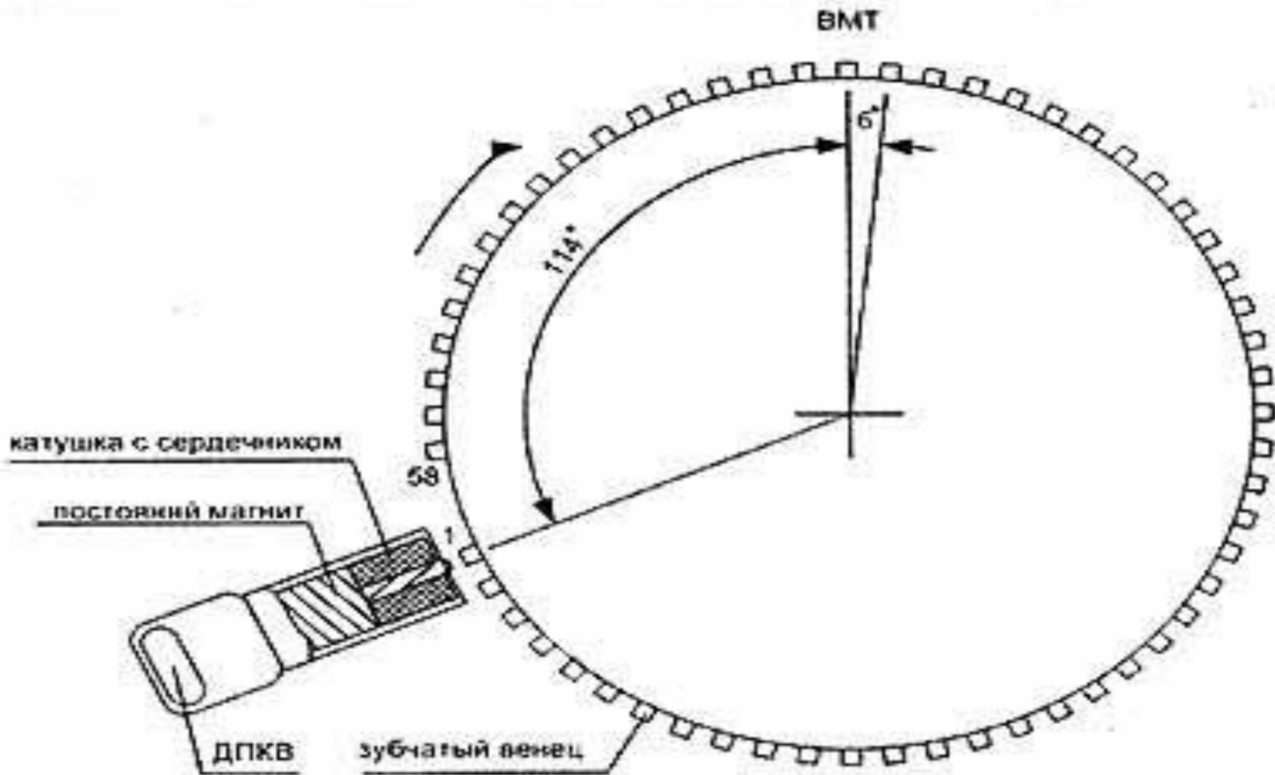
Опишите назначение датчика положения коленвала
