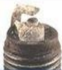
накопление отложений присадок топлива при сгорании
