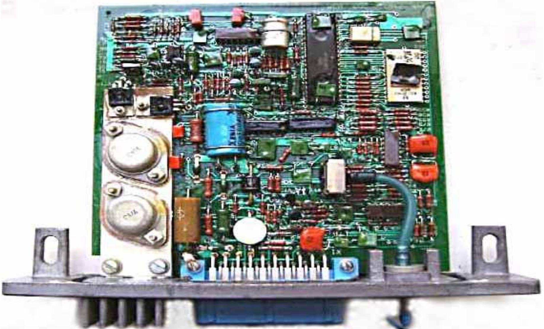
Опишите устройство и принцип работы коммутатора микропроцессорной системы зажигания
