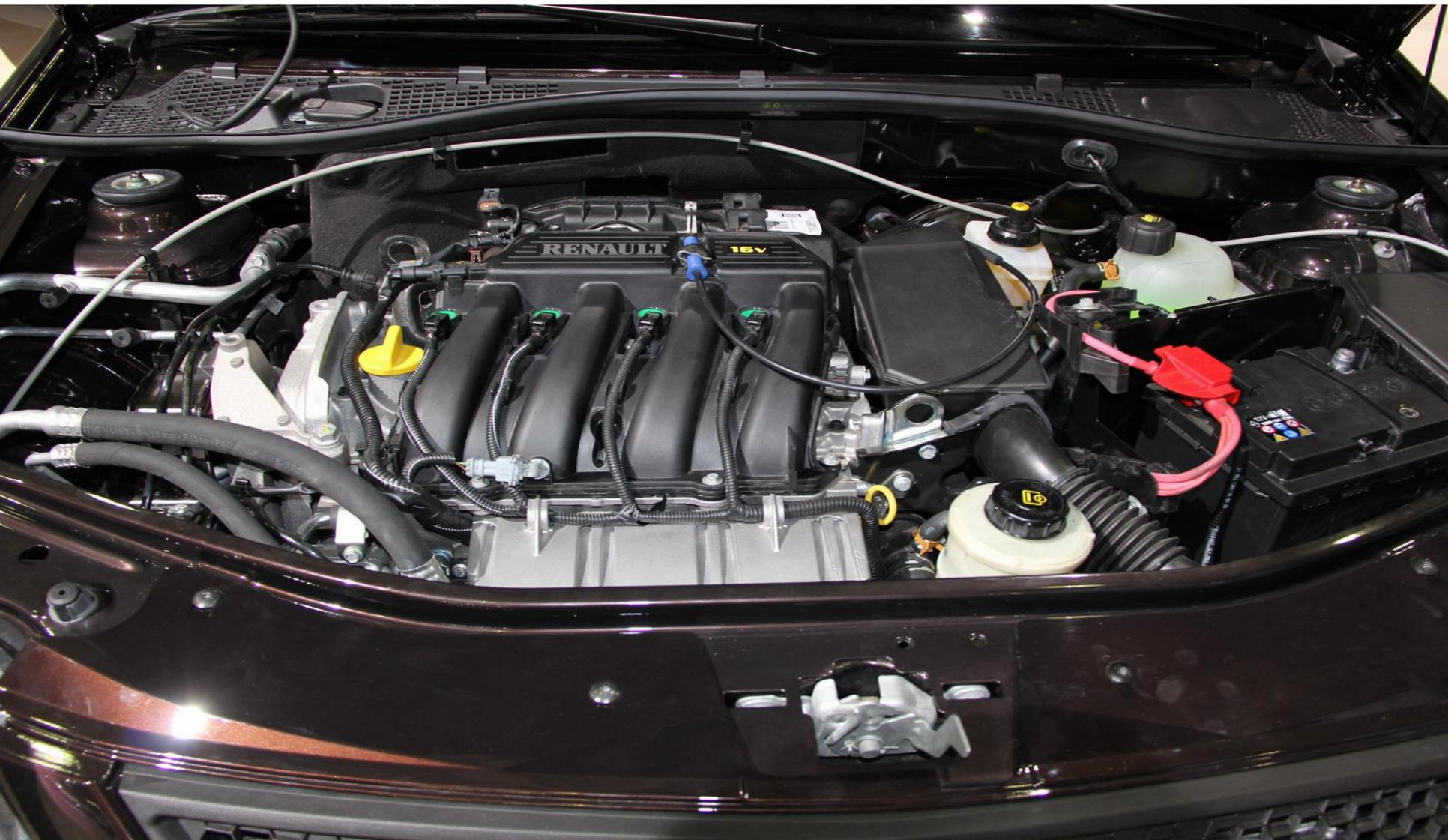
Электронной называется система зажигания, в которой создание и распределение тока высокого напряжения по цилиндрам двигателя осуществляется с помощью электронных устройств. Система имеет другое название - *микропроцессорная система зажигания*.
