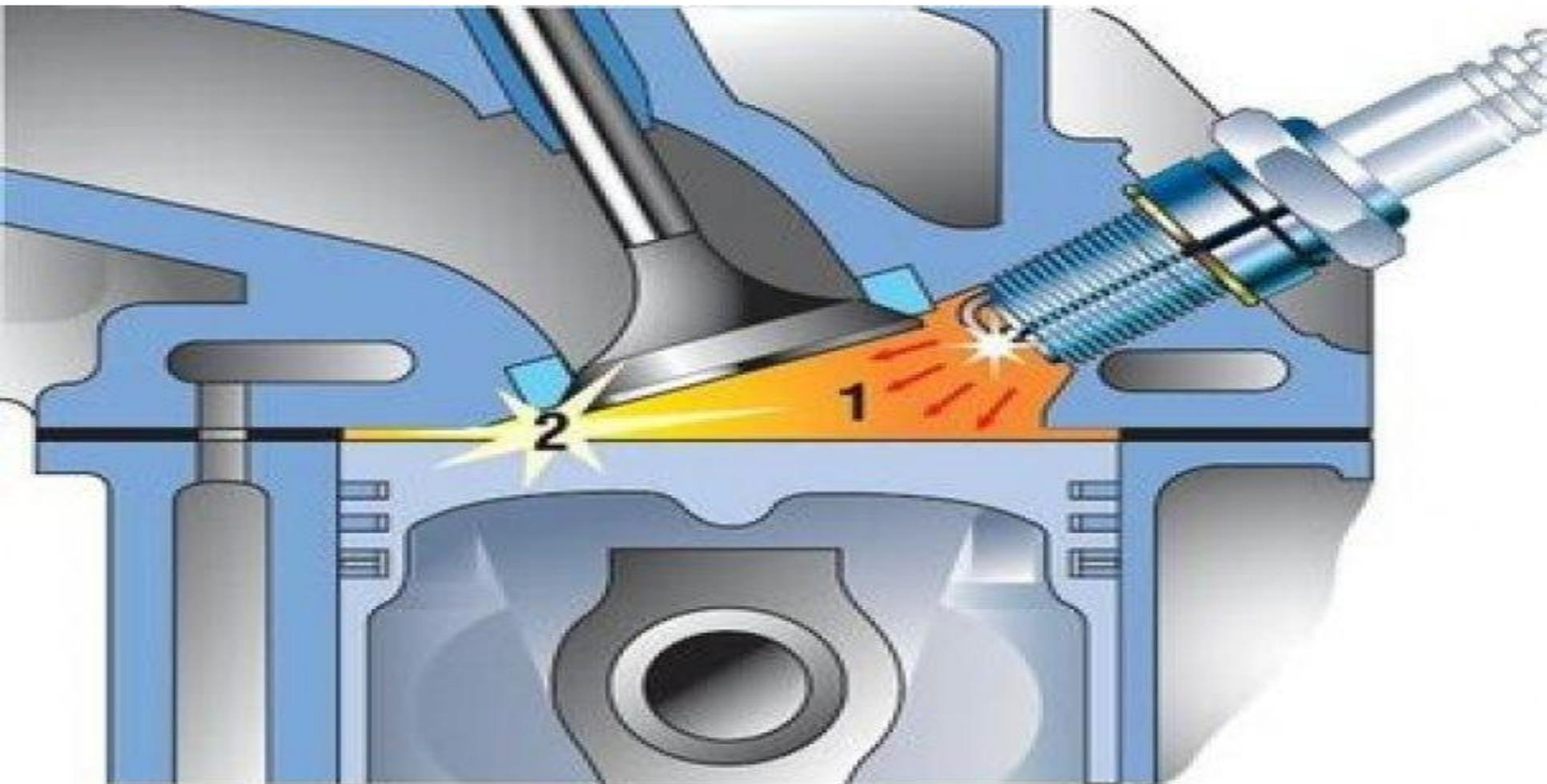
**Камера сгорания двигателя ВАЗ-2103:**
