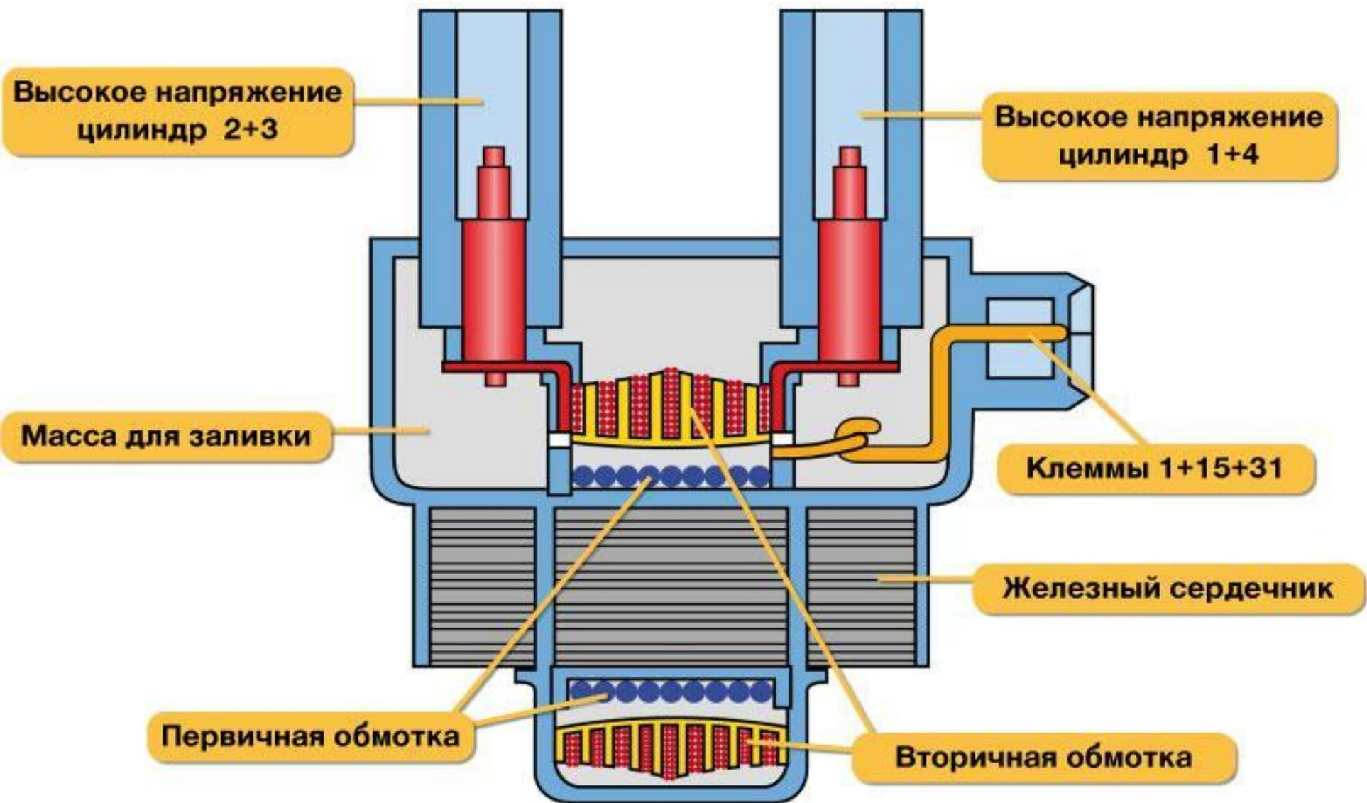
Опишите устройство и принцип работы модуля зажигания микропроцессорной системы зажигания
