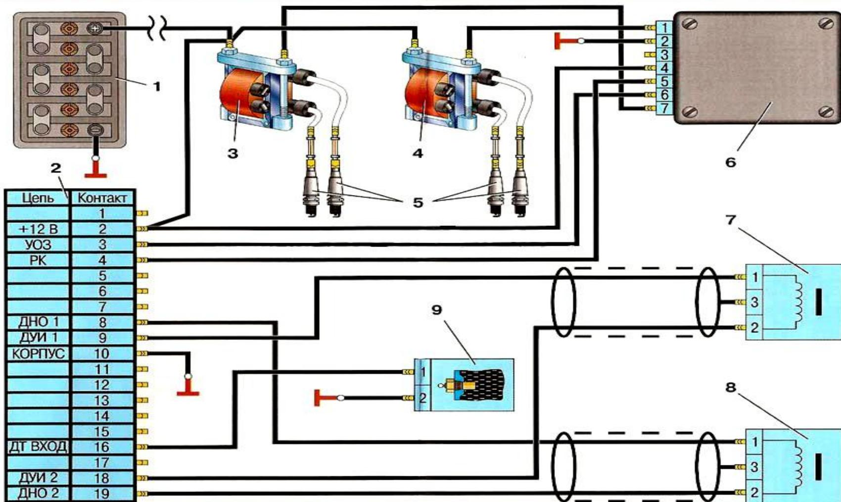
1 – аккумуляторная батарея; 2 – контроллер; 3 – катушка зажигания первого и четвертого цилиндров; 4 – катушка зажигания второго и третьего цилиндров; 5 – свечи зажигания; 6 – двух-канальный коммутатор зажигания; 7 – индуктивный датчик угловых импульсов (ДУИ); 8 – индуктивный датчик начала отсчета (ДНО); 9 – датчик температуры охлаждающей жидкости (ДТ)
