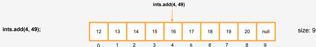
Перед добавлением методом **ensureCapacityInternal** проверяется заполняемость, если массив не заполнен, добавляется новый элемент и происходит сдвиг элементов в правую часть массива методом **System.arraycopy**
