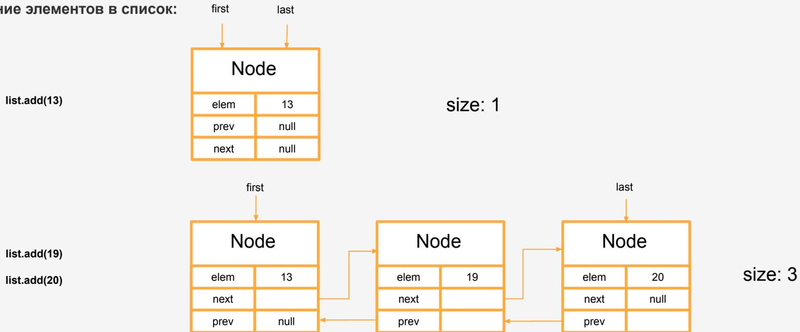
Для быстрого добавления элементов в начало и конец списка используются методы **addFirst(E e)** и **addLast(E e)**
