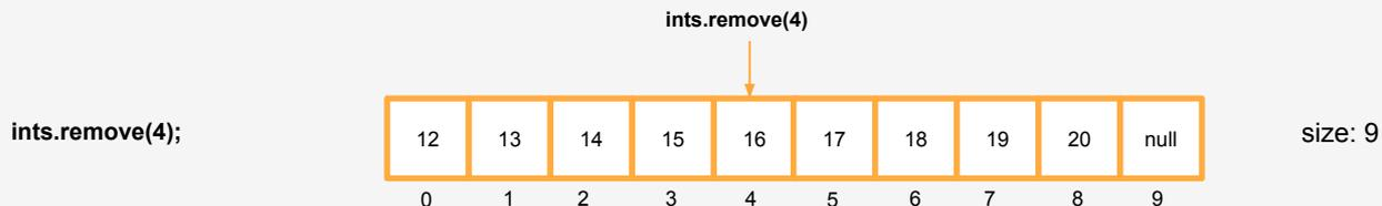
Рассчитывается количество элементов, которые необходимо сдвинуть после удаления и происходит сдвиг элементов копированием методом **System.arraycopy**
