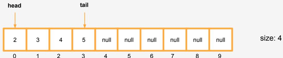
**ArrayDeque** работает по принципу **circular buffer**, за счет указателей **head** и **tail**
