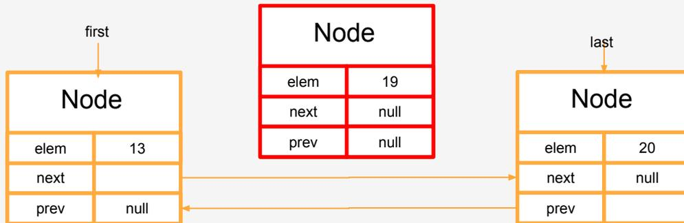
Для быстрого удаления элементов в начале и конце списка используются методы **removeFirst()** и **removeLast()**
