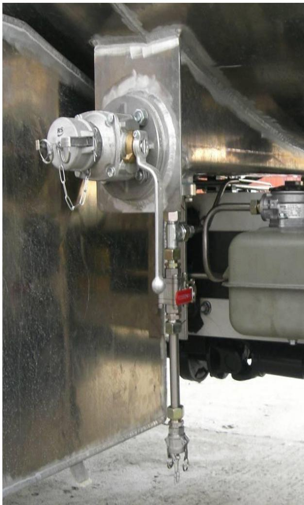
Предназначена для слива отстоя и отбора проб авиатоплива до, после ФВО, а также из отстойника ФВО и цистерны ТЗ.
