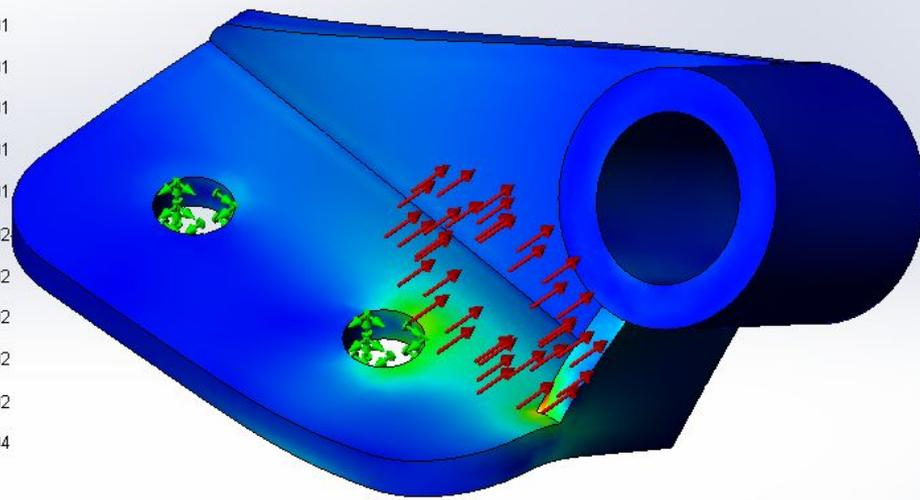
Эпюра деформации отражает результирующие деформации полученные в результате статического, нелинейного исследований и исследования на ударную нагрузку.
