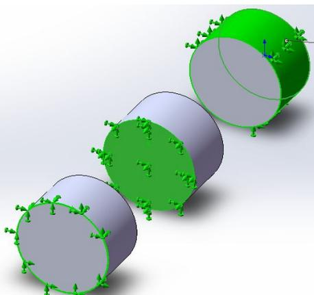
В общем случае, с использованием допускаемых способов закрепления, модель может быть лишена 6-ти степеней свободы – перемещений вдоль 3-х координатных осей и вращения вокруг них.
