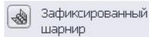
Закрепление **Шарнир**, позволяет задать вращение цилиндрической грани вокруг своей собственной оси или кромки. Радиус и длина цилиндрической грани постоянно остаются под нагрузкой.
