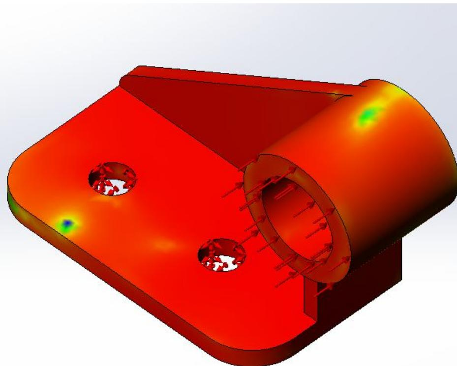
Эпюры запаса прочности строятся на основе выбранного критерия разрушения чтобы выявить слабые зоны конструкции.
