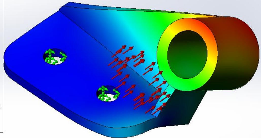
На эпюре перемещений можно отобразить перемещения и опорные реакции в направлении осей X, Y, Z, результирующие перемещения и опорные реакции.
